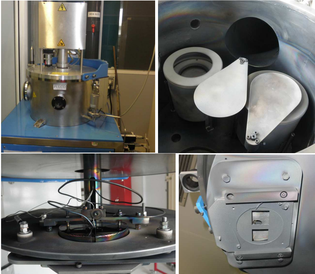
FIGURE 2.4 – (a) Vue extérieure du réacteur (b) Cathodes avec leurs caches (ouvert et fermé) (c) Porte-substrat vu de côté montrant le thermocouple (d) Porte-substrat vu de dessous montrant la résistance chauffante.
