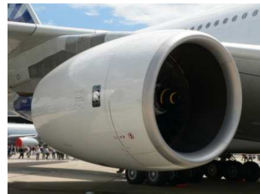
Figure I-2. Illustration des types de motorisation : turbopropulseurs sur ATR42 et turboréacteur (Rolls-Royce Trent 900) sur l'A380
