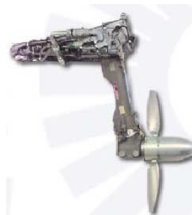
Figure I-4. RAT (Hamilton Sundstrand) installée sur les Airbus A330-A340 [LAN06]
