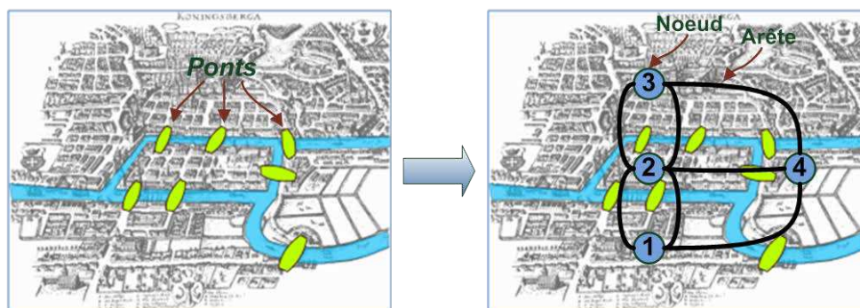
Figure II-6 Les 7 ponts de la ville de Königsberg modélisés par un graphe non orienté
