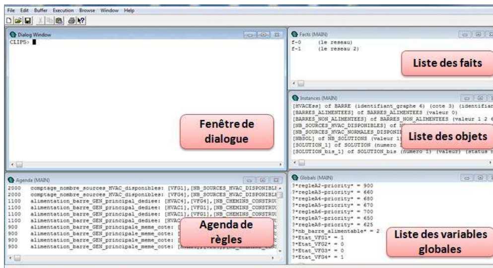
Figure II-19 L'interpréteur : environnement de développement CLIPS
