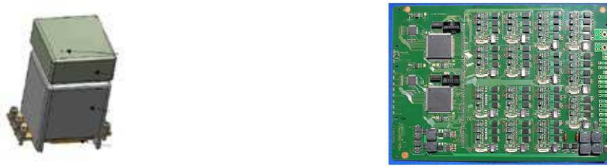
Figure I-24 RCCB de charge AC installé sur A400M (à gauche) ; SSPC de charge DC coupant à 15 A (à droite)
