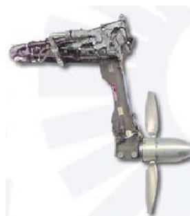
Figure I-4. RAT (Hamilton Sundstrand) installée sur les Airbus A330-A340 [LAN06]
