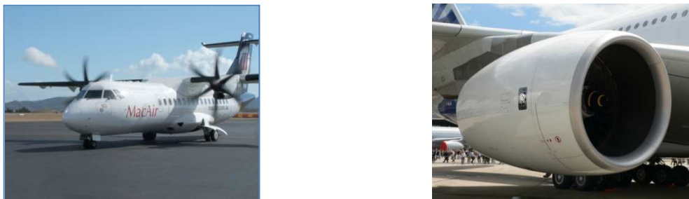
Figure I-2. Illustration des types de motorisation : turbopropulseurs sur ATR42 et turboréacteur (Rolls-Royce Trent 900) sur l'A380
