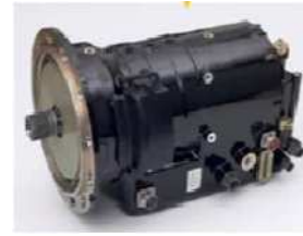
Figure I-15. VFG de 150 kVA embarqué dans un Airbus A380 [BAU09]
