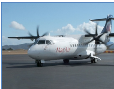
Figure I-2. Illustration des types de motorisation : turbopropulseurs sur ATR42 et turboréacteur (Rolls-Royce Trent 900) sur l'A380
