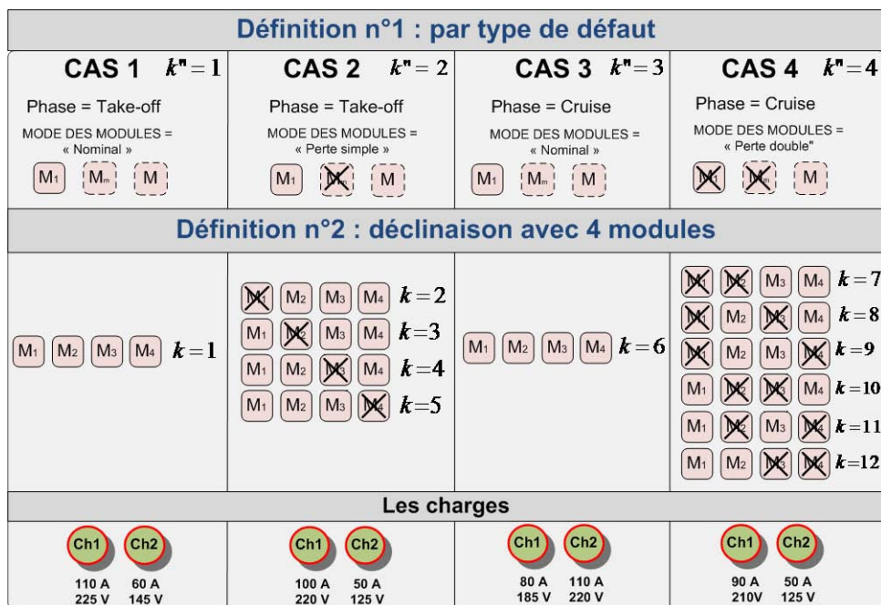
Figure IV-8 Représentation d'un problème avec le mode des modules représenté par ses deux définitions : « générique » et « particulière »
