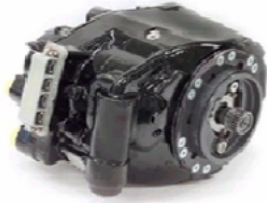
Figure I-14. IDG de 75 kVA embarqué dans un Airbus A340 [BAU09]
