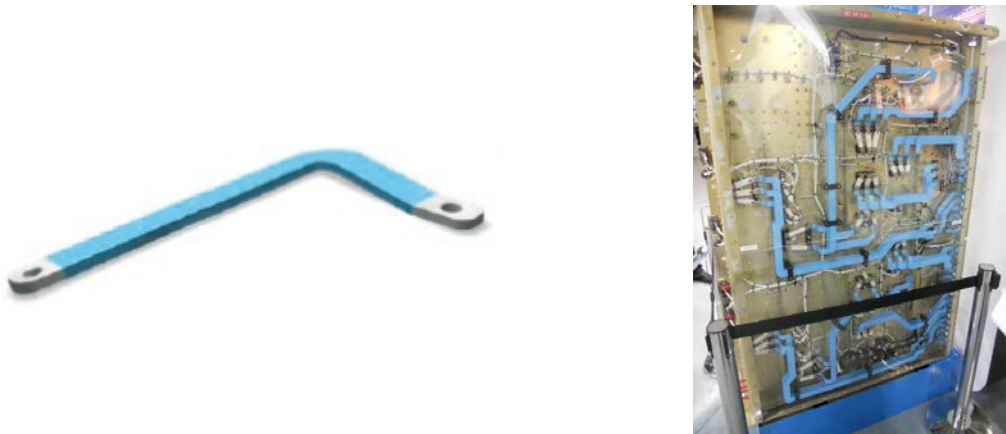
Figure I-21 A gauche : Barres électriques du cœur secours A380 (source Amphenol Air LB) – A droite : photo des barres d'un cœur électrique
