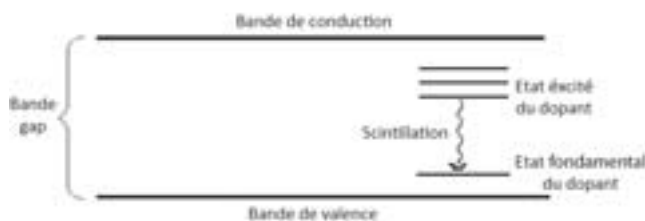
Fig. 2.23 – Diagramme représentant les états énergétiques introduits par un dopant [Knoll 10].
