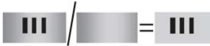
Fig. 4.9 – Principe de correction de champ de lumière.
