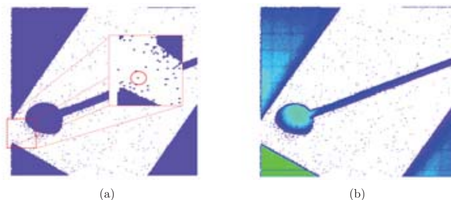
Fig. 4.19 – Comparaison entre une image reconstruite avant 4.19(a) et après 4.19(b) soustraction des pixels dégradant la qualité de l'image.
