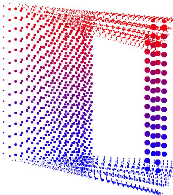
**FIGURE 2.38:** Distribution de température représentée sur une tranche du réacteur, en cœur et hors cœur, modélisée avec le modèle de cinétique point par zone
