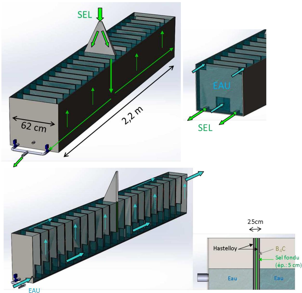
**FIGURE B.4:** Représentation schématique du fonctionnement du réservoir de vidange du sel combustible et son refroidissement par de l'eau ; en haut à gauche : la distribution du sel lors de la vidange ; en haut à droite : les gaps dans les plaques permettant l'écoulement de l'eau, et les tuyaux permettant l'écoulement du sel ; en bas à gauche : l'écoulement de l'eau le long du réservoir du sel ; en bas à droite : la coupe d'une plaque de séparation eau/sel
