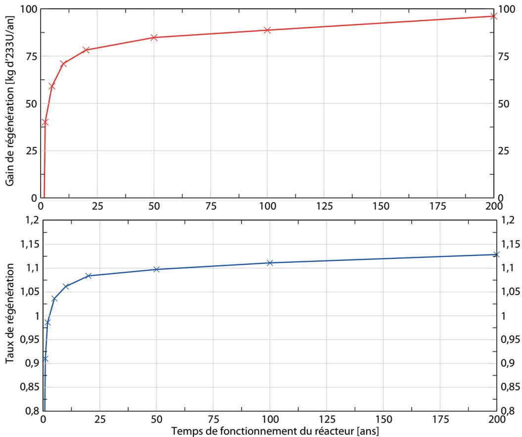
**FIGURE 2.16:** En haut : gain de régénération ; en bas : taux de régénération en fonction du temps de fonctionnement du réacteur
