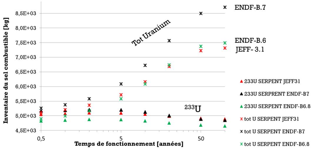
FIGURE 2.35: Évolution de l'inventaire du sel combustible en uranium et en  $^{233}\text{U}$  des évaluations de POLIMI (SERPENT) utilisant trois différentes bases de données ENDF-B.VI, ENDF-B.VII et JEFF-3.1
