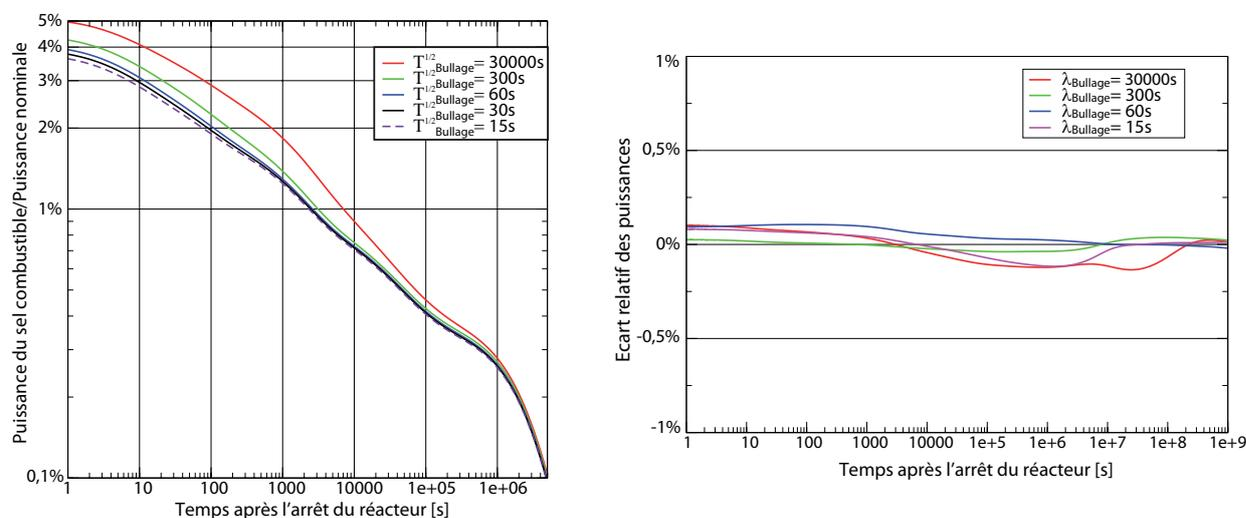
**FIGURE 4.12:** A gauche : sensibilité de la puissance résiduelle du sel combustible à la vitesse d'extraction des produits de fission par le système de bullage ; à droite : sensibilité de la somme des puissances du sel combustible, du système de bullage et de l'unité de retraitement à la vitesse d'extraction des produits de fission par le système de bullage
