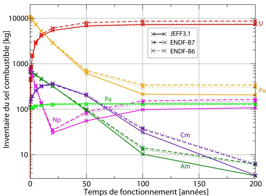
**FIGURE 2.33:** Évolution des inventaires du sel combustible en noyaux lourds et des produits de fission des évaluations de POLIMI (SERPENT) utilisant trois différentes bases de données ENDF-B.VI, ENDF-B.VII et JEFF-3.1
