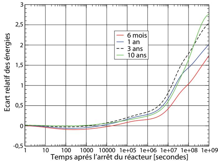
**FIGURE 4.15:** Écart relatif de l'énergie totale produite par les compositions du sel combustible après 6 mois, 1 an et 10 ans de fonctionnement pour un démarrage avec des TRU par rapport à celle de la composition d'équilibre après 100 ans de fonctionnement
