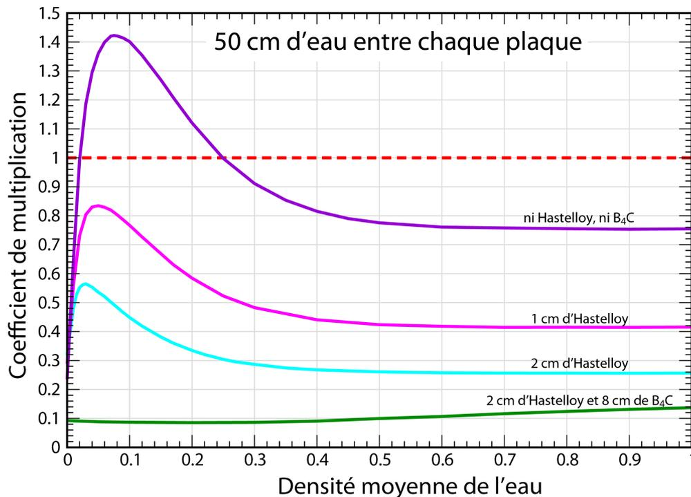
**FIGURE B.5:** Le coefficient de multiplication neutronique en fonction de la densité de l'eau dans la piscine évalué pour quatre configurations : 5 cm de sel combustible sans protection (en violet), 5 cm de sel combustible entouré d'1 cm d'alliage base nickel, appelé Hastelloy, (en rose), 5 cm de sel combustible entouré de 2 cm d'alliage base nickel (en bleu clair) et 5 cm de sel combustible entouré de 2 cm d'alliage base nickel et de 8 cm de  $B_4C$  (en vert)
