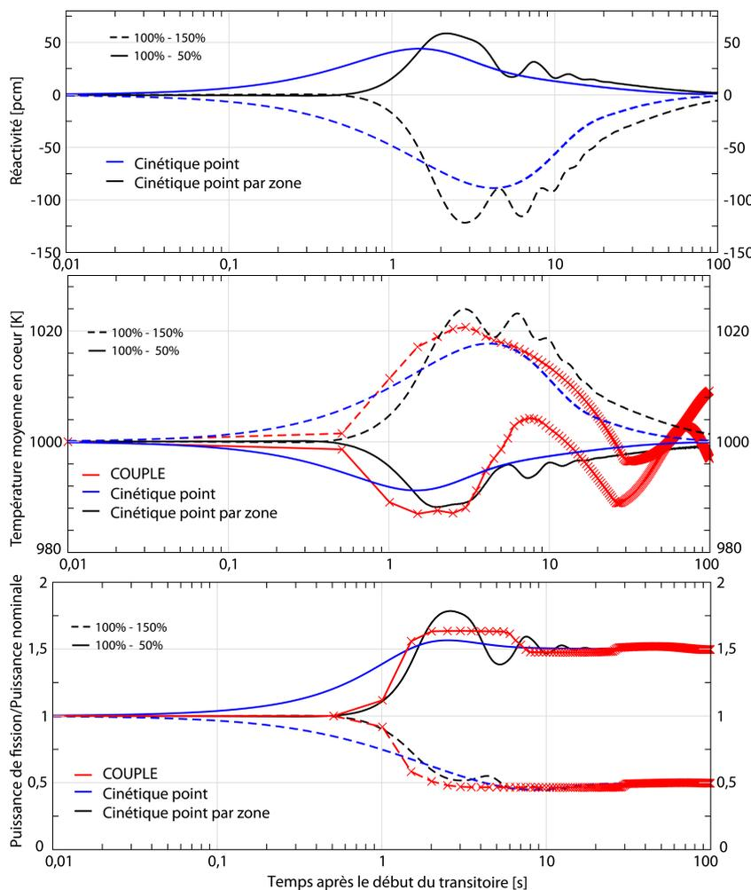
**FIGURE 2.40:** Variations de réactivité, de puissance de fission, et de température calculées avec le modèle cinétique point par zone (en noir) comparé au code COUPLE (en rouge) et au modèle cinétique point (en bleu - volume d'inertie thermique correspondant à 18 m<sup>3</sup> de sel), pour des variations instantanées de puissance extraite de 100 % à 150 % (en traits pleins) et à 50 % (en pointillés)
