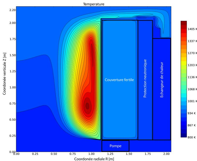
**FIGURE H.1:** Distribution de température du sel combustible obtenue avec le code COUPLE, utilisant un modèle de pompe imposant une vitesse purement horizontale en entrée cœur et d'échangeur de chaleur imposant une température d'entrée cœur
