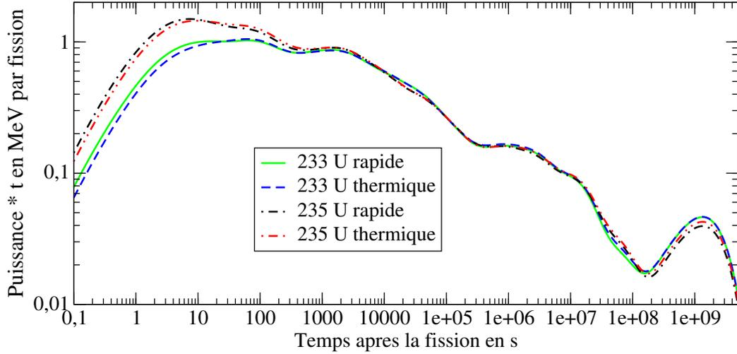
**FIGURE 4.5:** Puissance résiduelle des produits de fission suite à une fission pour les deux noyaux  $^{233}\text{U}$  (courbes verte et bleue) et  $^{235}\text{U}$  (courbes noire et rouge) en spectre rapide et thermique; base de données des rendements de fission : JEFF-3.1.1
