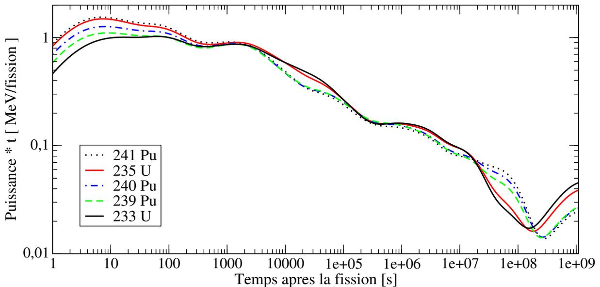
**FIGURE 4.8:** Puissance résiduelle des produits de fission suite à une fission en spectre rapide pour cinq noyaux :  $^{233}\text{U}$ ,  $^{235}\text{U}$ , ainsi que  $^{239}\text{Pu}$ ,  $^{240}\text{Pu}$  et  $^{241}\text{Pu}$ ; la puissance résiduelle des produits de fission du  $^{238}\text{Pu}$  n'est pas représentée sur le graphe pour des raisons de lisibilité
