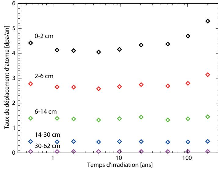
**FIGURE 2.17:** Taux de déplacements d'atome dans les matériaux de structure en fonction du temps de fonctionnement du réacteur, pour des couches de profondeur différentes du réflecteur axial supérieur
