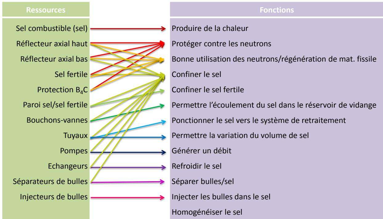
**FIGURE 3.10:** Ressources et fonctions du sous-système circuit combustible, les associations des fonctions aux ressources sont indiquées par les flèches, dont la couleur sert à améliorer la lisibilité du schéma
