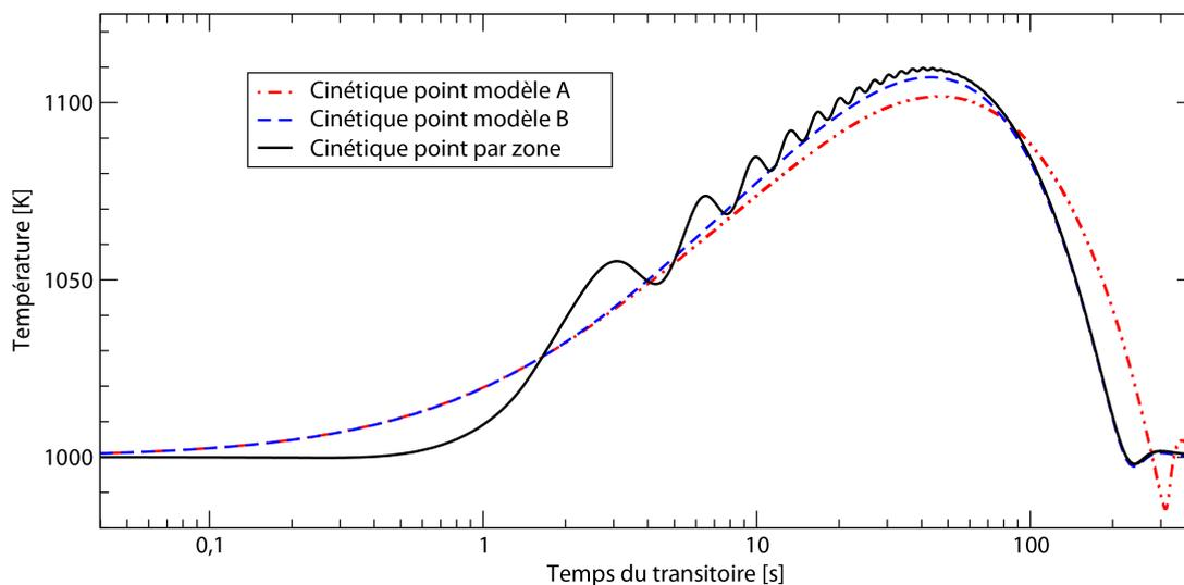
**FIGURE G.1:** Évolution de la température en fonction du temps suite à une baisse instantanée de 100% à 4% de la puissance extraite évaluée avec le modèle A de cinétique point, et le modèle B utilisant directement  $\beta_{utile}^i$  et le modèle de cinétique point par zone
