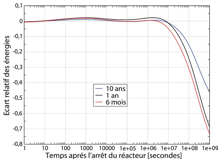
**FIGURE 4.14:** Écart relatif de l'énergie totale produite par les compositions du sel combustible après 6 mois, 1 an et 10 ans de fonctionnement relativement à celle de la composition d'équilibre après 100 ans de fonctionnement
