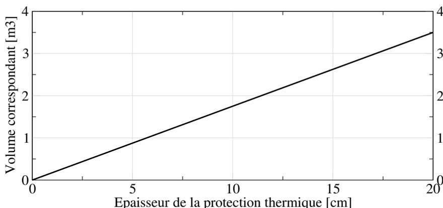
**FIGURE 5.2:** Volume autour du cœur neutronique occupé en fonctionnement normal par la protection thermique radiale en fonction de son épaisseur (évaluation d'après l'expression analytique de la géométrie)
