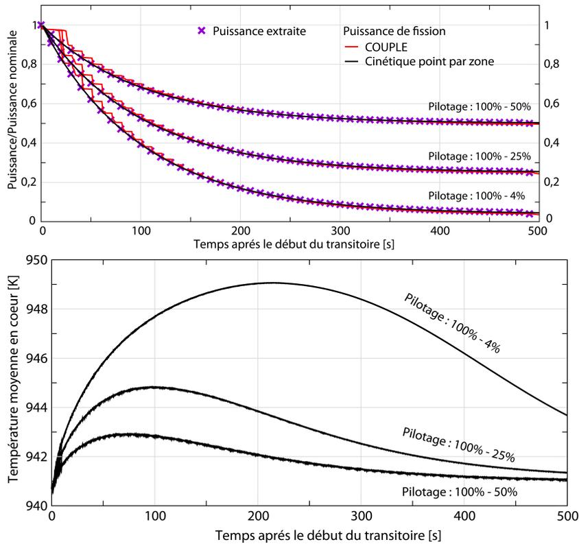
**FIGURE 2.41:** Haut : variation de puissance de fission calculée avec le modèle cinétique point par zone (en noir) comparé au code COUPLE (en rouge), pour une baisse exponentielle de la puissance extraite de 100 % vers 50 %, 25 % et 4 % selon  $\exp(-t/\tau)$ , avec  $\tau = 100$  s ; bas : variation de température calculée avec le modèle cinétique point par zone pour ces trois transitoires
