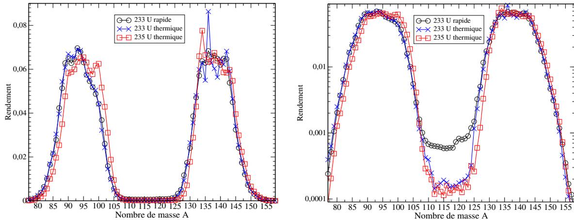
**FIGURE 4.4:** Distribution des fragments de fission en fonction de leur nombre de masse A pour l' $^{235}\text{U}$  en spectre thermique ( $\langle E_{\text{neutron}} \rangle = 0,0235$  eV, en rouge) et l' $^{233}\text{U}$  en spectres rapide ( $\langle E_{\text{neutron}} \rangle = 500$  keV, en noir) et thermique (en bleu); à gauche en représentation linéaire - à droite en représentation logarithmique; base de données des rendements de fission : JEFF-3.1.1
