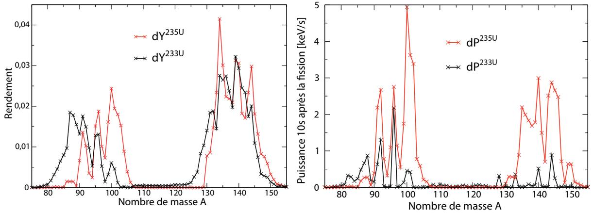
**FIGURE 4.7:** A gauche : Différence des rendements de fission  $dY_i$  de  $^{235}\text{U}$  en spectre thermique et de  $^{233}\text{U}$  en spectre rapide en fonction du nombre atomique  $A$  ; à droite : Puissance émise 10 s après la fission par les vecteurs isotopiques des différences de rendements de fission de  $^{233}\text{U}$  en spectre rapide et  $^{235}\text{U}$  en spectre thermique respectivement  $dY_i^{235U}$  et  $dY_i^{233U}$ , en fonction du nombre atomique  $A$
