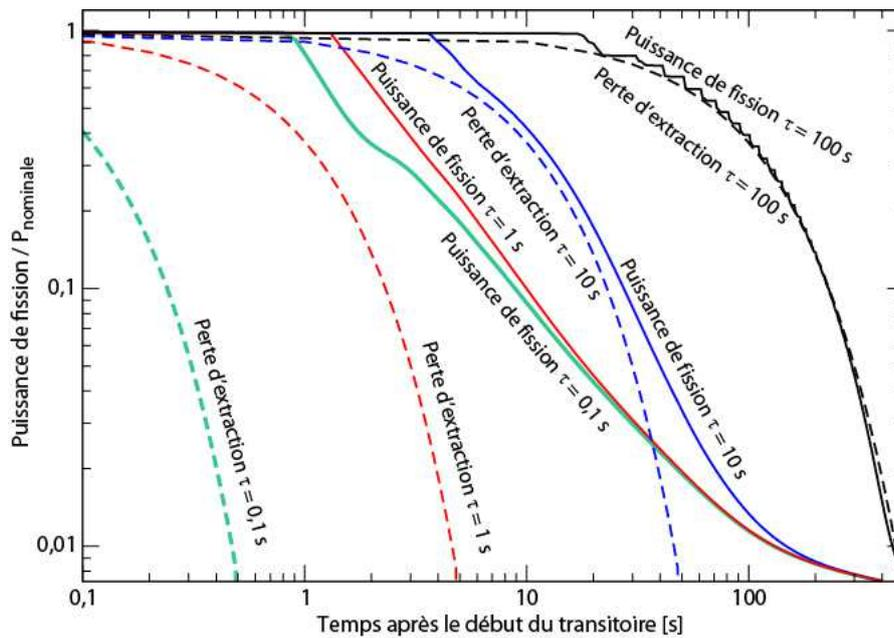
**FIGURE 5.9:** Puissance extraite (en traits pointillés) et puissance de fissions (en trait plein) correspondante pour un transitoire de perte de la source froide par palier suivant une exponentielle de temps caractéristique 0,1 s (en vert), 1 s (en rouge), 10 s (en bleu) et 100 s (en noir)
