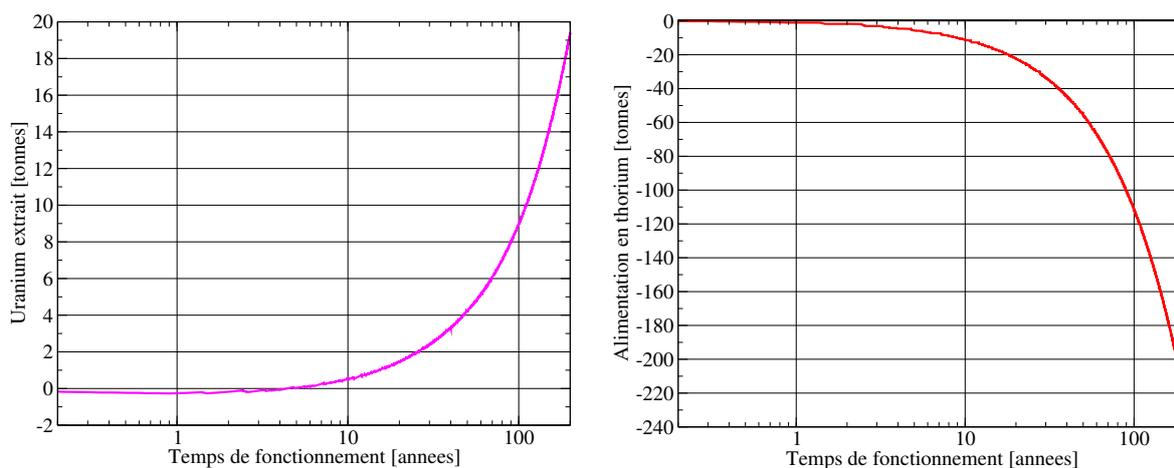
**FIGURE 2.14:** A gauche : production d'uranium, correspondant au bilan hors cœur : uranium produit dans la couverture - alimentation en uranium du sel combustible ; à droite : alimentation en thorium du sel combustible en fonction du temps de fonctionnement du réacteur
