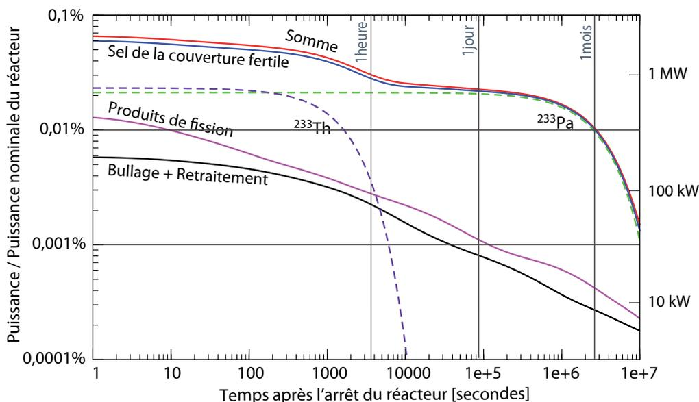
**FIGURE 4.16:** Puissance résiduelle du sel de la couverture fertile, avec les contributions des produits de fission et des deux actinides principaux ( $^{233}\text{Th}$  et  $^{233}\text{Pa}$ ) contenus dans le sel fertile, avec la puissance du système de bullage et de l'unité de retraitement associés à la couverture fertile
