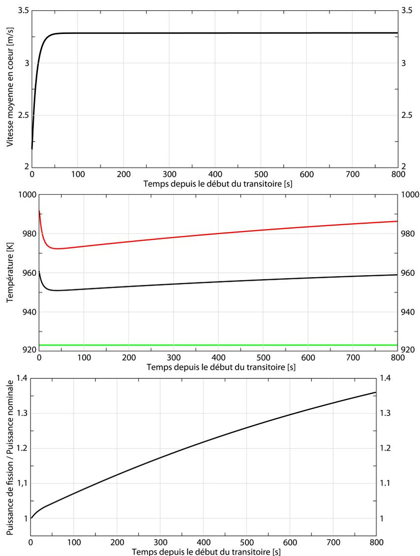
**FIGURE 5.13:** Vitesse et température moyennes en cœur, température en entrée et en sortie du cœur et puissance de fission en cœur suite à une augmentation de la vitesse moyenne du sel en cœur de 100% à 150% de sa valeur nominale selon une loi exponentielle avec un temps caractéristique  $\tau$  de 10 secondes
