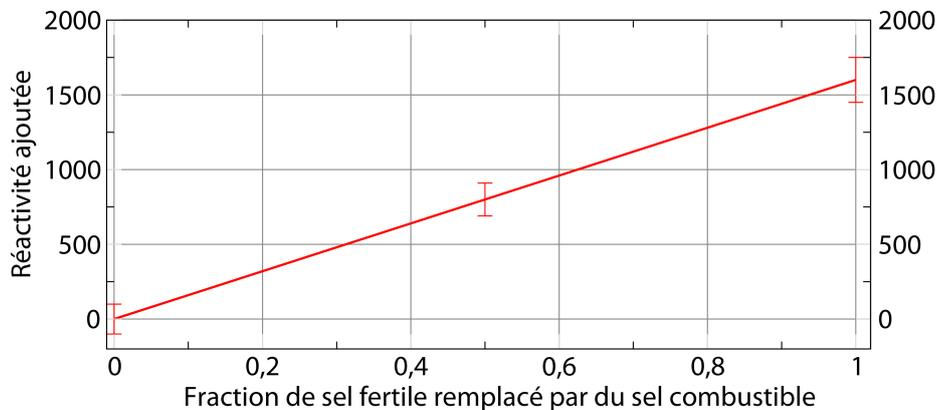
**FIGURE 5.3:** Variation de réactivité en fonction de la fraction de sel fertile remplacé par du sel combustible
