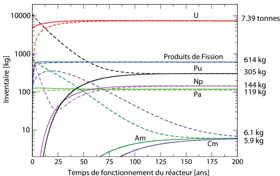
**FIGURE 2.15:** Évolution de la composition du sel combustible en fonction du temps de fonctionnement du réacteur, pour la configuration de démarrage à  $^{233}\text{U}$  en traits pleins et le démarrage aux TRU en traits pointillés
