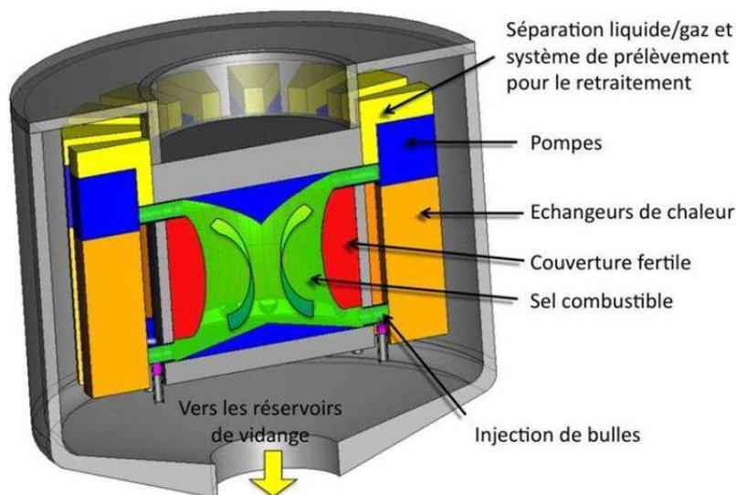
**FIGURE 2.1:** Schéma de principe du cœur et des boucles de recirculation du MSFR : sel combustible (en vert transparent), couverture fertile (en rouge), pompes (en bleu) et échangeurs de chaleur (en orange)
