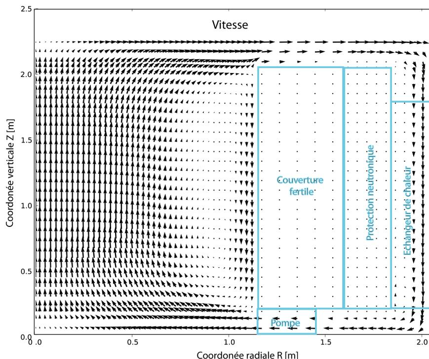
**FIGURE H.2:** Champs de vitesse du sel combustible obtenue avec le code COUPLE, utilisant un modèle de pompe imposant une vitesse purement horizontale en entrée cœur et d'échangeur de chaleur imposant une température d'entrée cœur
