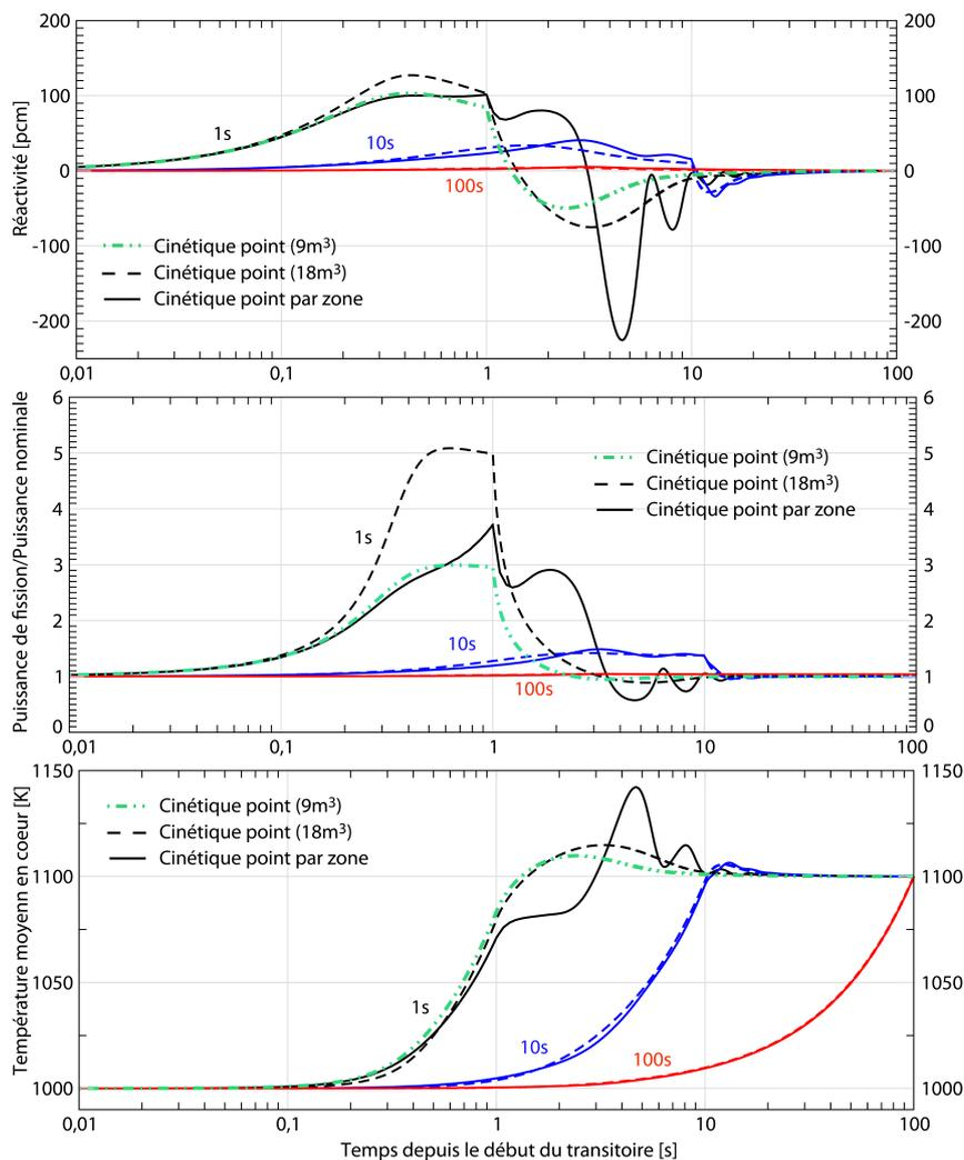
**FIGURE 5.5:** Variations de réactivité, de puissance de fission, et de température calculées avec le modèle cinétique point par zone comparé au modèle cinétique point (volume d'inertie thermique de  $18 \text{ m}^3$ ), pour une insertion de réactivité de 500 pcm en 1 s (en noir), 10 s (en bleu) et 100 s (en rouge); l'insertion de réactivité en 1 s est également présentée avec le modèle cinétique point pour un volume d'inertie thermique équivalent à  $9 \text{ m}^3$
