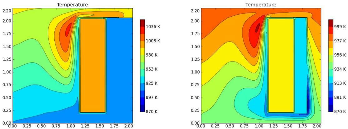
**FIGURE 2.39:** Distribution de température des états stationnaires avec deux modèles de l'échangeur de chaleur : à gauche en imposant une puissance extraite et à droite en imposant une température au sel combustible ; entre le cœur neutronique et la boucle de recirculation (contenant l'échangeur de chaleur et la pompe), se trouvent la couverture fertile et la protection neutronique ( $B_4C$ ) telles que définies dans le benchmark neutronique
