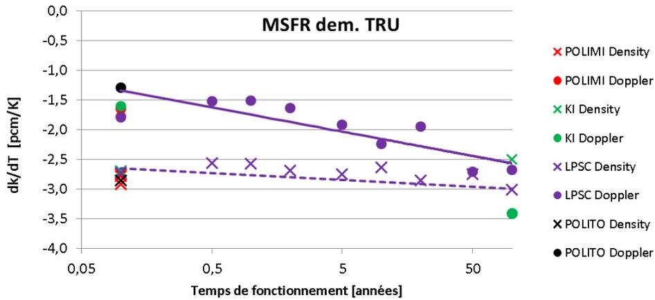
FIGURE 2.30: Évolution du coefficient de contre-réactions en fonction du temps de fonctionnement du MSFR suite pour un démarrage aux TRU, correspondant aux données des tables de la figure 2.29
