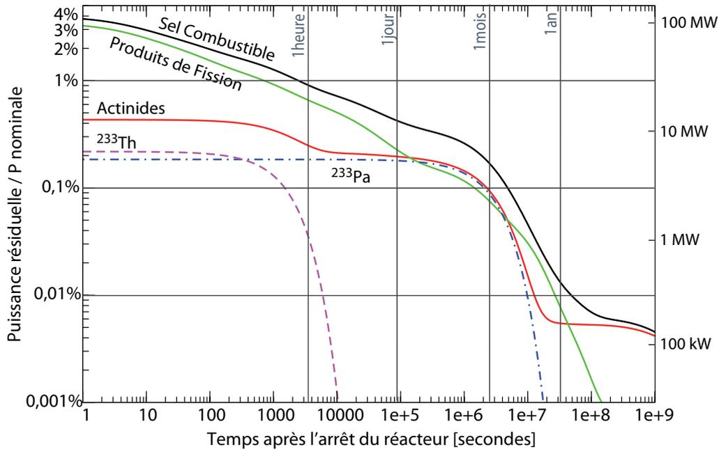
**FIGURE 4.11:** Puissance résiduelle du sel combustible et ses deux contributions : les produits de fission et les actinides, avec le détail de la puissance produite par le  $^{233}\text{Th}$  et le  $^{233}\text{Pa}$
