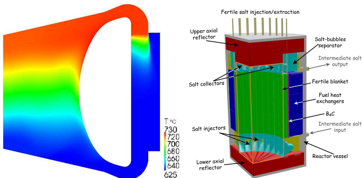
**FIGURE 2.5:** Sur la gauche : distribution de température du sel combustible dans le cœur [23] et dans la boucle de recirculation du MSFR; Sur la droite : vue schématique d'un quart du cœur du réacteur et des systèmes l'entourant, le sel combustible circulant dans le sens montant en cœur et descendant dans les boucles de recirculation
