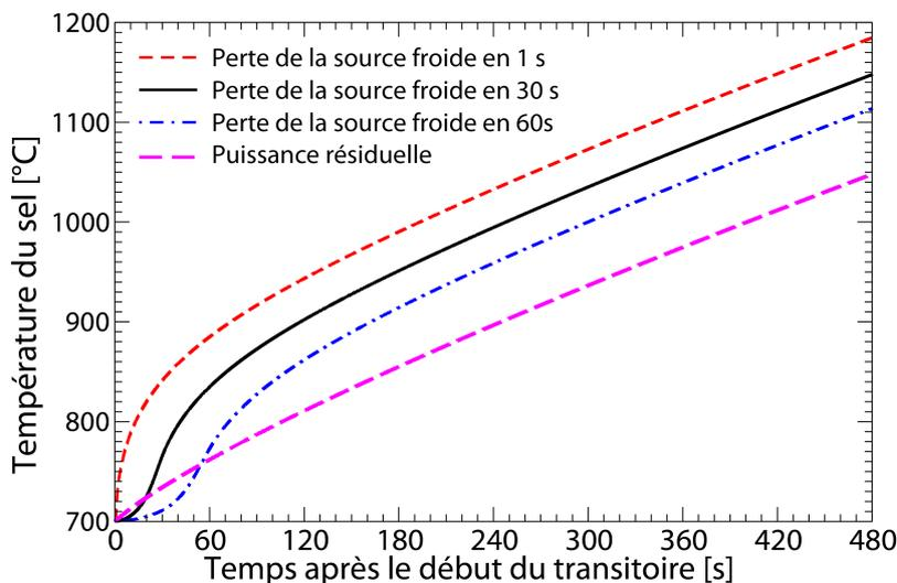
**FIGURE 5.8:** Température du sel combustible en considérant seulement la puissance résiduelle (en rose), évaluée avec le modèle cinétique point par zone pour une perte de la source froide en 1 s (en rouge), 30 s (en noire) et 60 s (en bleu)
