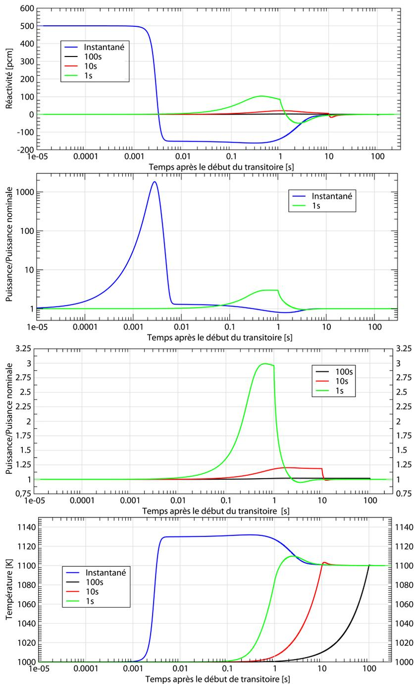
**FIGURE 5.4:** Variations de réactivité, de puissance de fission, et de température calculées avec le modèle cinétique point pour une insertion de réactivité de 500 pcm instantanée (en bleu), en 1 s (en vert), 10 s (en rouge) et 100 s (en noir)
