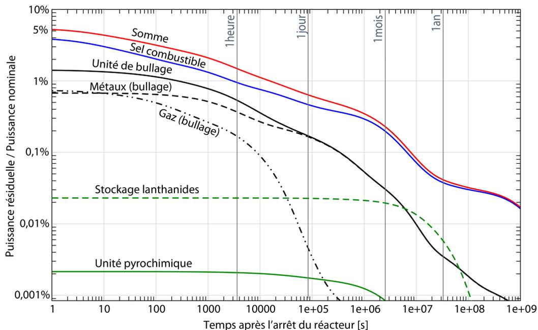
**FIGURE 4.10:** Puissance résiduelle du réacteur MSFR dans le sel combustible, l'unité de bullage, l'unité de retraitement et somme de ces puissances après 100 ans de fonctionnement du réacteur démarré à  $^{233}\text{U}$  avec une modélisation plus précise de l'unité de retraitement et l'unité de bullage
