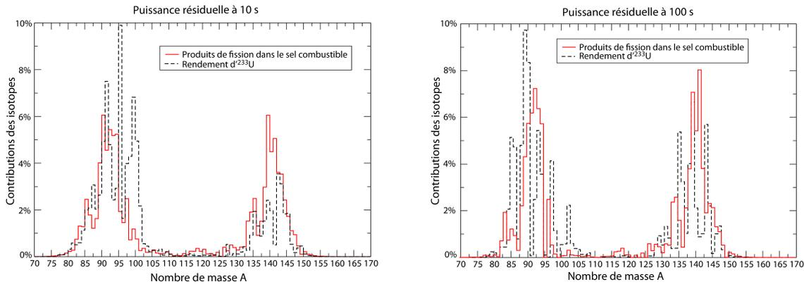
**FIGURE 4.17:** Contribution à la chaleur résiduelle des produits de fission en fonction du nombre de masse A pour la composition à l'équilibre et la composition de démarrage à  $^{233}\text{U}$ , équivalent à une fission élémentaire ; à gauche : 10 s après l'arrêt de la réaction en chaîne ; à droite : 100 s après l'arrêt de la réaction en chaîne
