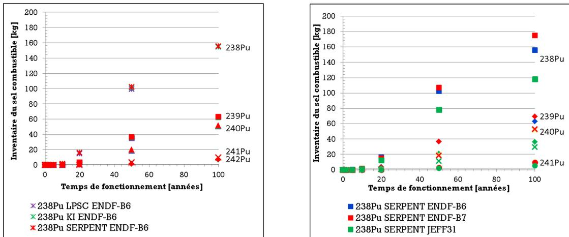
FIGURE 2.36: À gauche : évolution de l'inventaire des isotopes de plutonium évalué par POLIMI (SERPENT), KI et LPSC avec la même base de données ENDF-B.VI ; à droite : évolution de l'inventaire du sel combustible des isotopes de plutonium évalué par POLIMI (SERPENT) avec trois différentes bases de données (ENDF-B.VI, ENDF-B.VII et JEFF-3.1)
