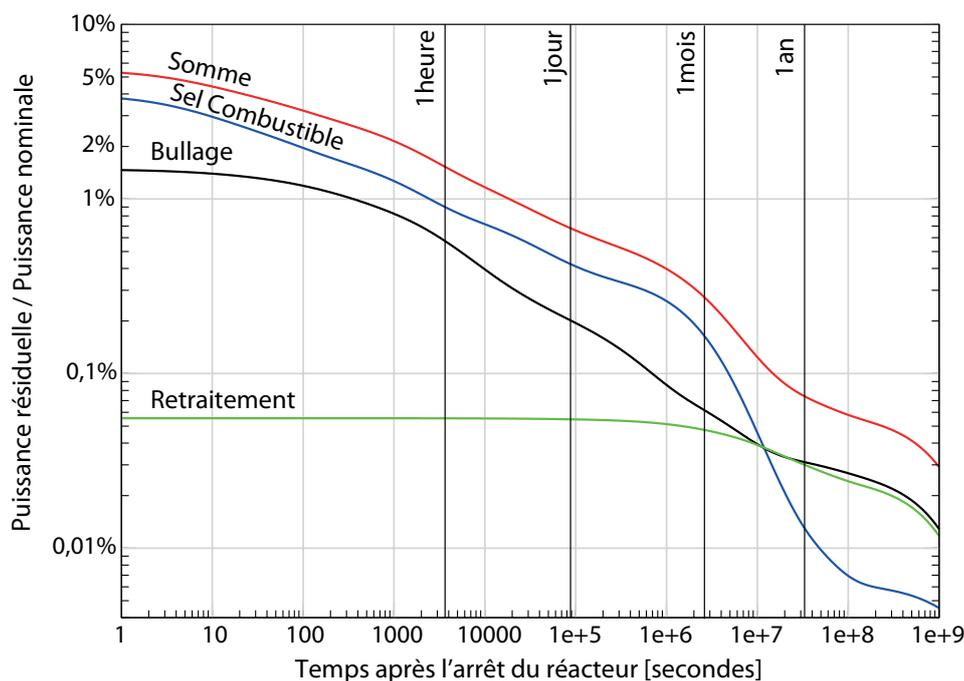
**FIGURE 4.9:** Puissance résiduelle du réacteur MSFR dans le sel combustible (en bleu), l'unité de bullage (en noir) et l'unité de retraitement (en vert), et somme de ces puissances (en rouge) après 100 ans de fonctionnement du réacteur démarré à l' $^{233}\text{U}$
