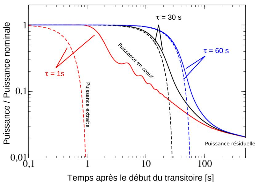
**FIGURE 5.7:** Transitoires évalués avec le modèle cinétique point par zone pour une perte de la source froide en 1 s, 30 s et 60 s : puissance extraite (courbes pointillées) et la puissance générée par le sel combustible avec les fissions et puissance résiduelle (courbes pleines)
