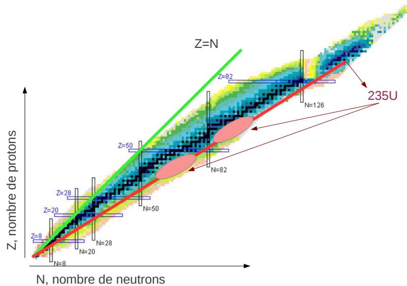
FIGURE 1.7: Carte des nucléides (Z, N) avec la représentation de la vallée de stabilité : les noyaux stables en noir, et les noyaux instables en bleu, vert, jaune avec une durée de vie décroissante ; une représentation schématique de la fission de l' $^{235}\text{U}$
