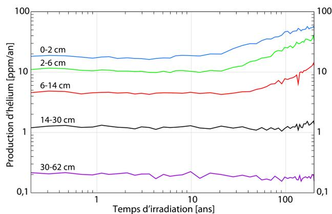
**FIGURE 2.20:** Production moyenne d'hélium en fonction du temps d'irradiation et de la profondeur à laquelle s'effectue cette production du réflecteur axial supérieur en utilisant la base de données JEFF-3.1
