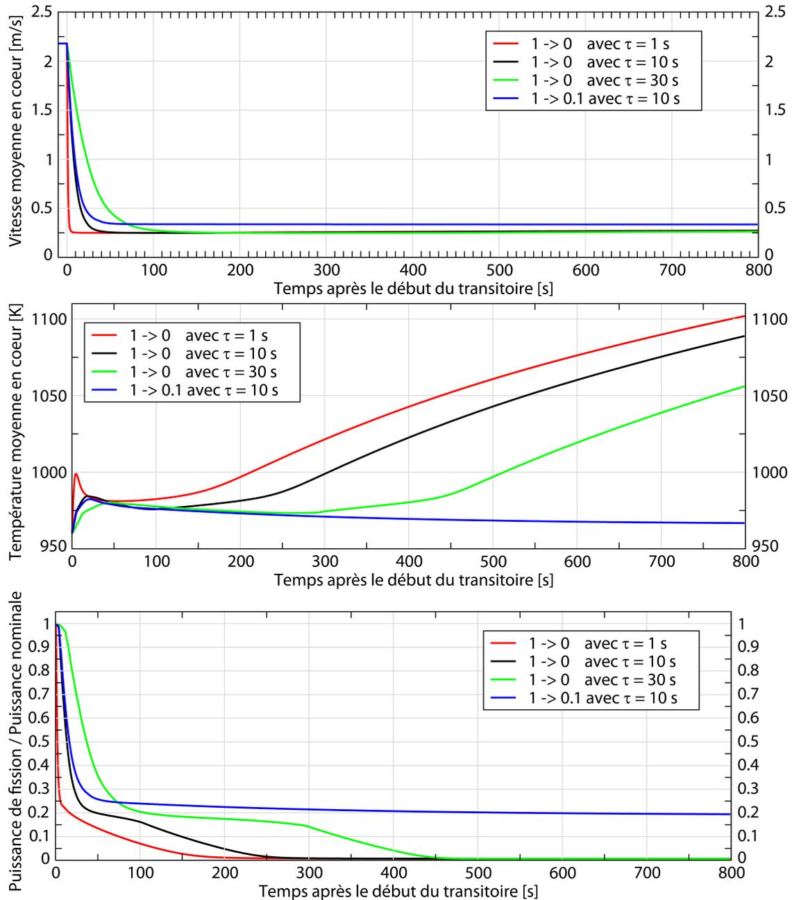
**FIGURE 5.11:** Transitoires de baisse du débit de 100%  $\rightarrow$  0% avec  $\tau = 1$ , 10 s et 30 s, et de 100%  $\rightarrow$  10% avec  $\tau = 10$  s : vitesse et température moyennes en coeur et puissance de fission normalisée en fonction du temps après le début du transitoire
