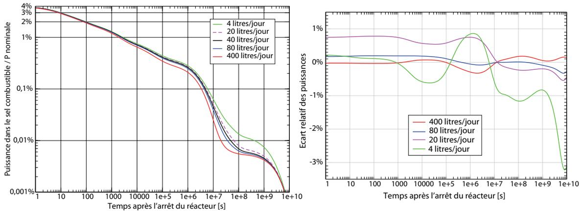
**FIGURE 4.13:** A gauche : sensibilité de la puissance résiduelle du sel combustible à la vitesse de retraitement chimique des produits de fission ; à droite : sensibilité de la somme des puissances du sel combustible, système de bullage et unité de retraitement à la vitesse de retraitement chimique des produits de fission
