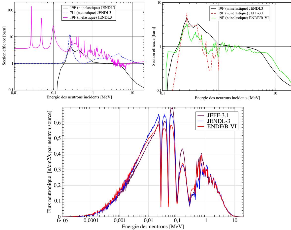
**FIGURE 2.11:** A gauche : Section efficace de diffusion élastique du  $^{19}\text{F}$  et du  $^7\text{Li}$ , et section efficace de diffusion inélastique du  $^{19}\text{F}$  extraites de la base JENDL-3 ; à droite : Sections efficaces de diffusion inélastiques du  $^{19}\text{F}$  extraites des bases JENDL-3, ENDF/B-VI et JEFF-3.1 ; En dessous : Spectre neutronique pour la composition du démarrage à  $^{233}\text{U}$  calculé avec les bases de données JENDL-3, ENDF/B-VI et JEFF-3.1
