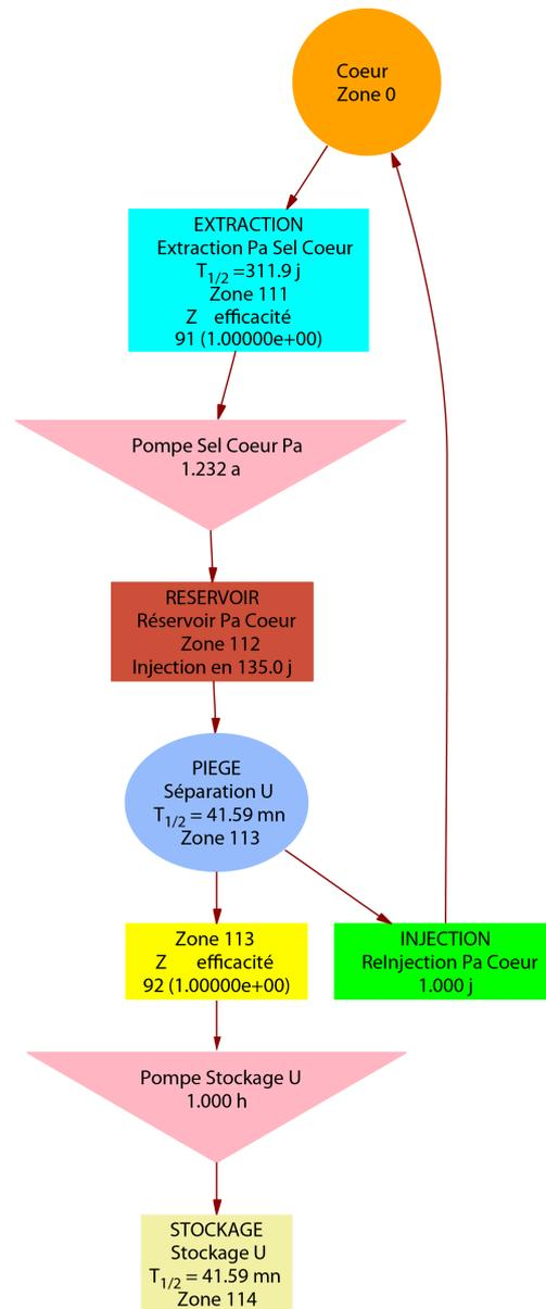
**FIGURE D.4:** Modélisation du retraitement fictif du protactinium du sel combustible permettant un meilleur ajustement de la criticité du réacteur pendant l'évolution
