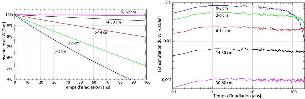
**FIGURE 2.21:** A gauche : inventaire en tungstène; à droite : taux de transmutation du tungstène en fonction du temps d'irradiation et de la profondeur à laquelle s'effectue cette production du réflecteur axial supérieur
