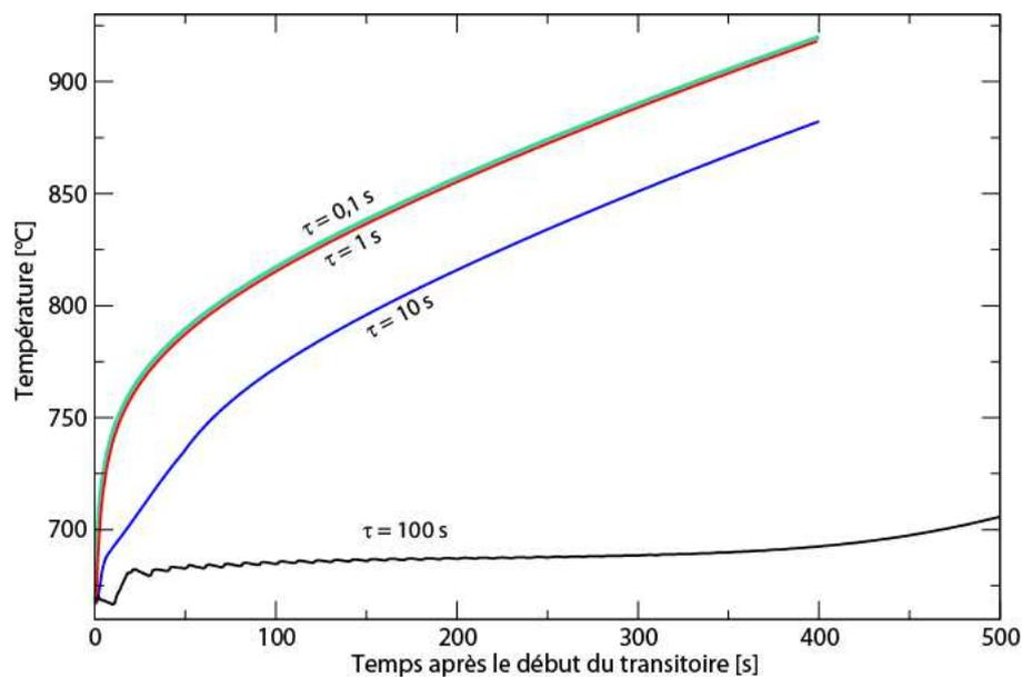
**FIGURE 5.10:** Température moyenne du sel combustible en cœur suite à un transitoire de perte de la source froide par palier et exponentiellement en 0,1 s (en vert), 1 s (en rouge), 10 s (en bleu) et 100 s (en noir)
