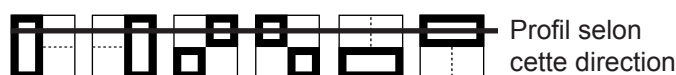
Figure 2.14 – Directions du profil sur les différents shares. De gauche à droite (les contours de) : V_0 , V_1 , D_1 , D_0 , H_1 et H_0 .
