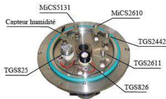
Figure 18. Exemple de nez électronique de laboratoire constitué d'une matrice de capteurs commerciaux [68]
