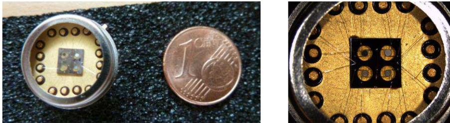
**Figure 55.** Photographies du multicapteur assemblé
