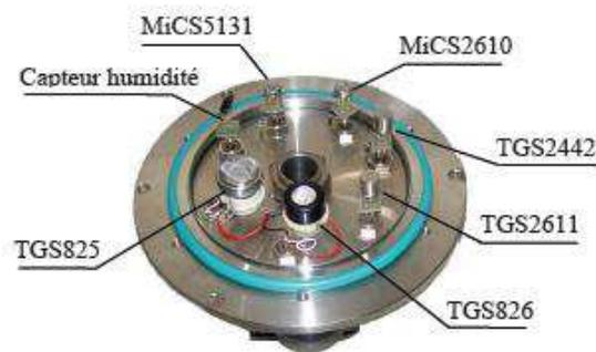
**Figure 18.** Exemple de nez électronique de laboratoire constitué d'une matrice de capteurs commerciaux [68]
