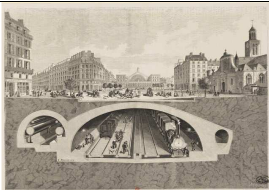
Fig. n°13. Paris Projet de chemin de fer souterrain de la villette aux halles centrales 1861,
