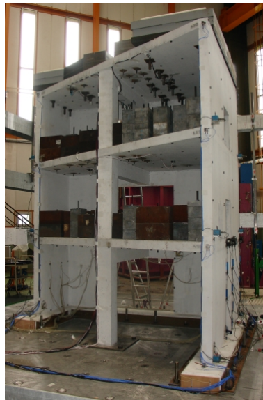
Figure 2.13: Maquette SMART 2008 chargée et placée sur la table sismique Azalée du CEA.
