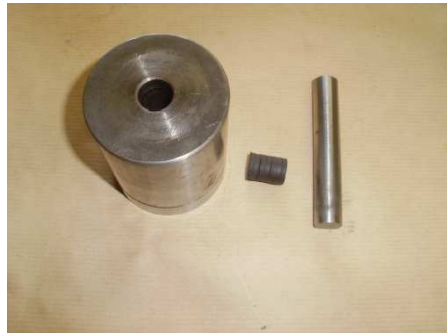
FIGURE 1.10 – Dispositif chambre piston et éprouvette de Deltane 350 constituée d'un empilement d'échantillons cylindriques [152].
