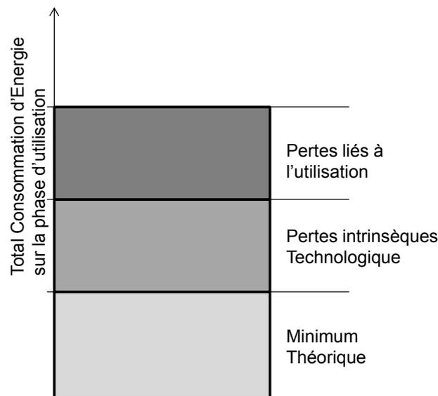
Figure 39 : Profil énergétique d'un produit électrique et électronique
