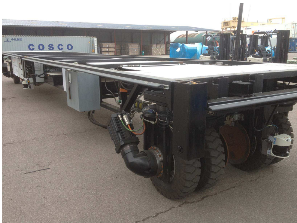
FIGURE 5.9 – Image réelle du premier prototype RobuTainer
