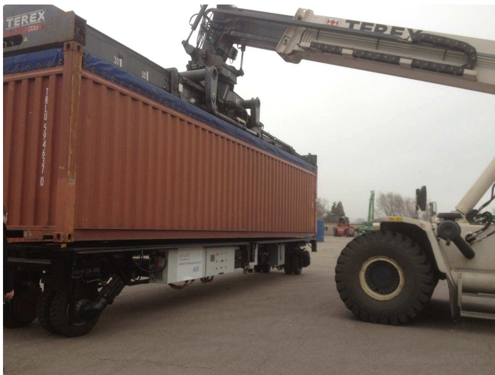
FIGURE 5.10 – Image réelle du transport d'un conteneur par le RobuTainer
