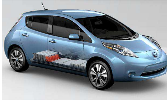
Figure 1.7. Pack de batterie Li-ion de 24kWh pour le véhicule électrique Nissan LEAF.
