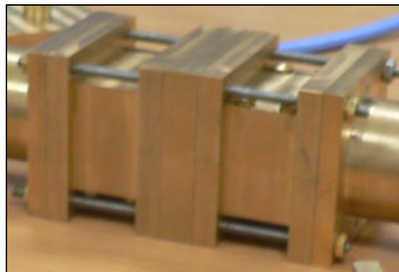
Figure 53 : Guide d'onde carré réalisé en deux tronçons
