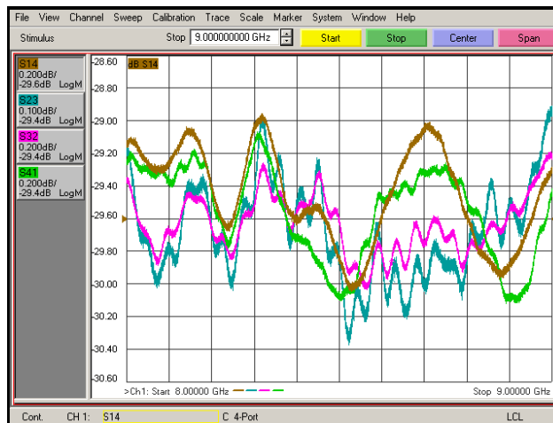
Figure 61 : Coefficient de transmission des composantes croisées en dB du système 'à vide' en fonction de la fréquence
