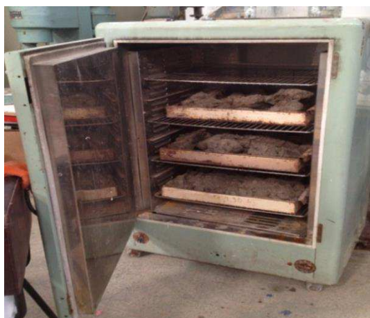
(a) Etuvage des sédiments à 50°C
