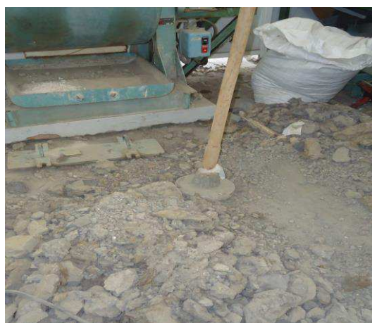
(b) Concassage des sédiments
