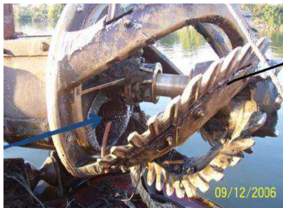
Photo 1. 2. Entrée du tuyau d'aspiration et lames d'une drague hydraulique (Palermo et al, 2008)
