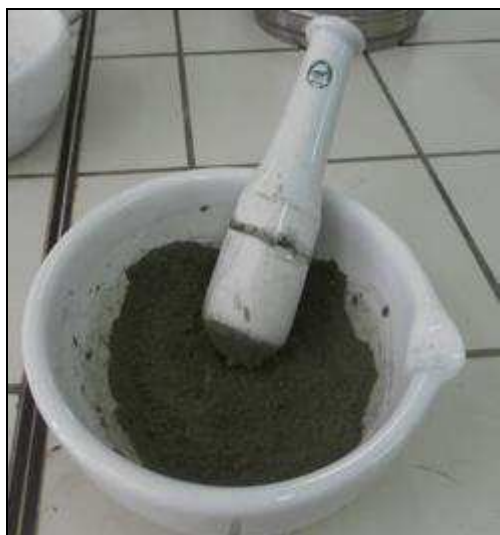
a. Broyage de l'échantillon
