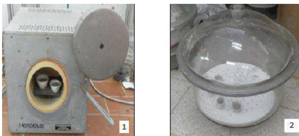
Photo 2. 4. Détermination de la teneur en matière organique par la méthode de la perte au feu
