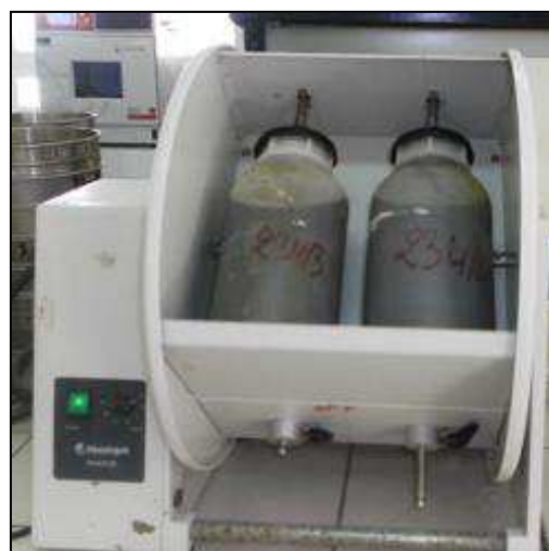
b. Retournement des flacons (5tr/min) pendant 24h
