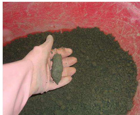
(b) Vérification de la consistance du mélange
