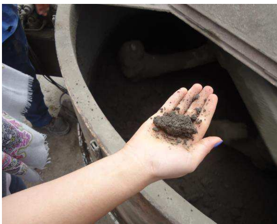
(d) Vérification de la consistance de la pâte
