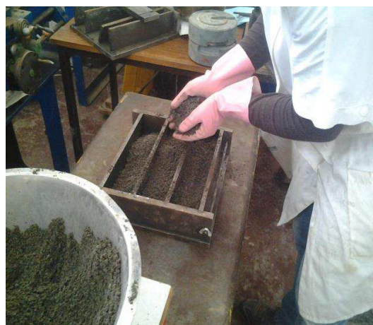
(b) Coulage de la 1 ère couche du
