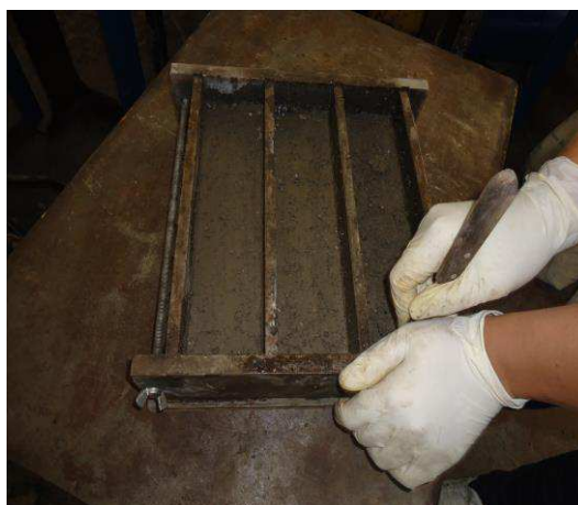
(d) Scarification de la 1 ère couche
