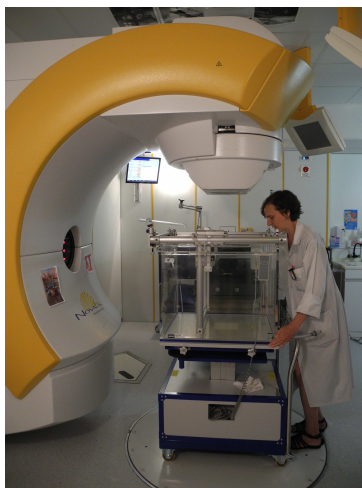
FIGURE VI.25 – Positionnement de la cuve à eau (Blue Phantom IBA) sous l'accélérateur Novalis pour les mesures en mini-faisceaux avec SCDDo-W, au Centre René Gauducheau.
