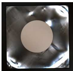
FIGURE III.19 – Image de biréfringence d'un diamant de 4 \times 4 \times 0,55 \text{ mm}^3 présentant des contacts en aluminium de 2 mm de diamètre déposés sur chacune de ses faces.
