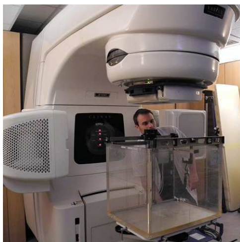
FIGURE IV.14 – Mise en place de la cuve à eau PTW sous l'accélérateur Varian 2100C muni du mMLC m3 pour réaliser les mesures dans l'eau avec les premiers prototypes de dosimètre diamant.
