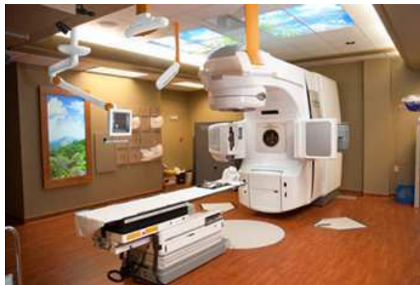
FIGURE I.3 – Accélérateur Novalis dédié à la radiothérapie stéréotaxique, muni du système ExacTrac X-ray 6D pour un positionnement précis du patient.
