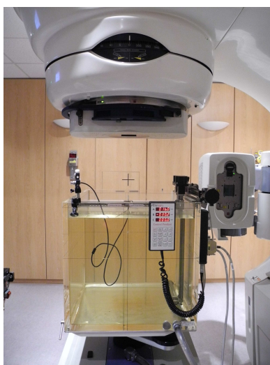
FIGURE VI.15 – Cuve à eau PTW placée sous l'accélérateur Varian 2100C équipé du mMLC m3 de Brainlab, à l'hôpital de la Pitié Salpêtrière à Paris.
