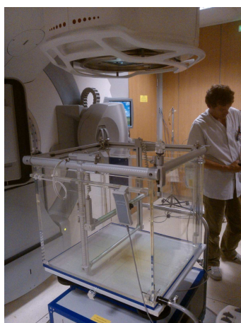
FIGURE VI.27 – Positionnement de la cuve à eau (Blue Phantom IBA) sous l'accélérateur Elekta Synergy pour les mesures en mini-faisceaux avec SCDDo-W.
