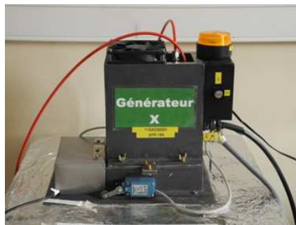
FIGURE III.33 – Tube RX permettant de faire des tests préliminaires des détecteurs diamant sous un faisceau de photons avec une énergie maximale de 50 keV et un débit de 60 \text{ Gy} \cdot \text{min}^{-1} .
