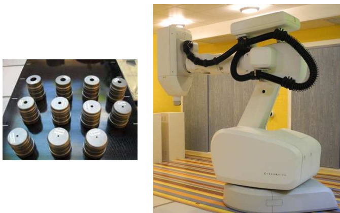
FIGURE I.4 – Accélérateur CyberKnife de l'Institut de Cancérologie de Lorraine Alexis Vautrin (Nancy), muni de collimateurs circulaires permettant d'obtenir des faisceaux de 5 mm à 60 mm de diamètre.
