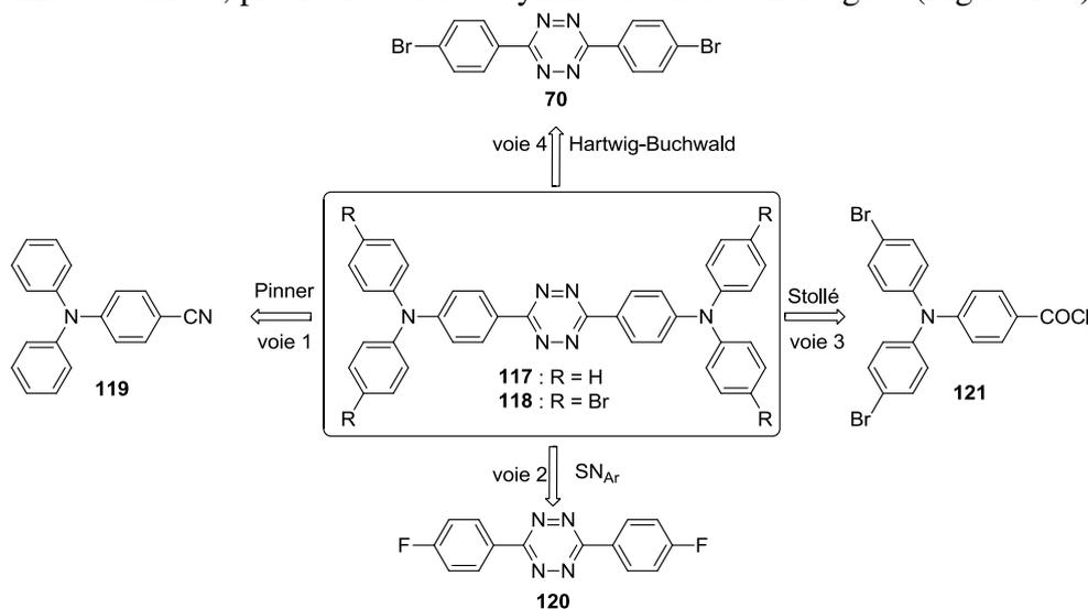
Figure 175. Rétrosynthèses des composés **117** et **118**
