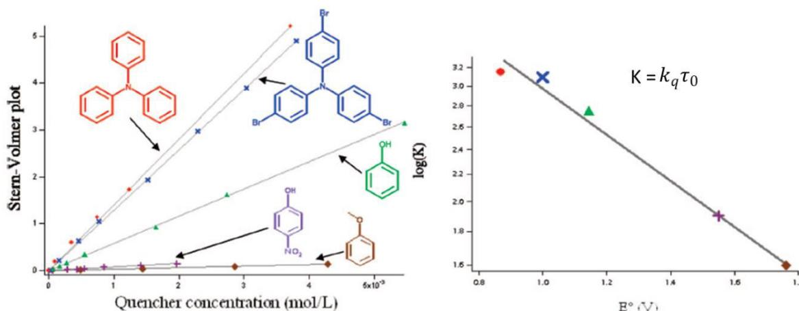
Figure 59. Étude de la tétrazine #70 : vérification des équations a) de Stern-Volmer b) de Rehm-Weller
