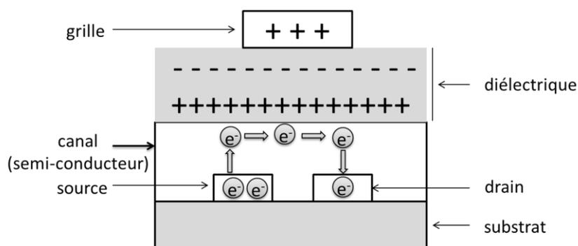
Figure 197. Fonctionnement d'un transistor de type n
