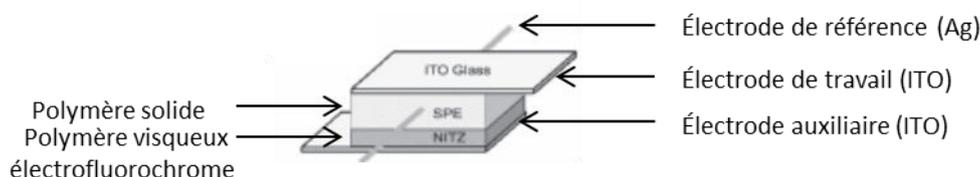
Figure 60. Fenêtre électrofluorescente
