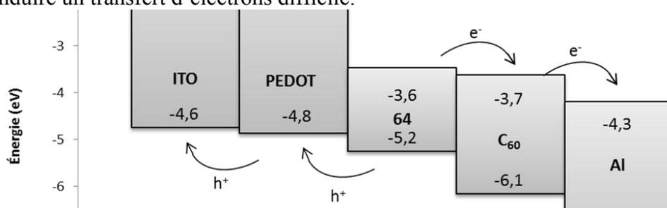
Figure 193. Diagramme énergétique de la cellule photovoltaïque fabriquée
