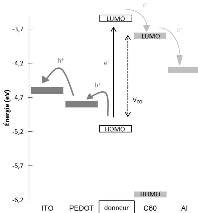
Figure 151. Niveaux d'énergie des orbitales des différents constituants de la cellule photovoltaïque
