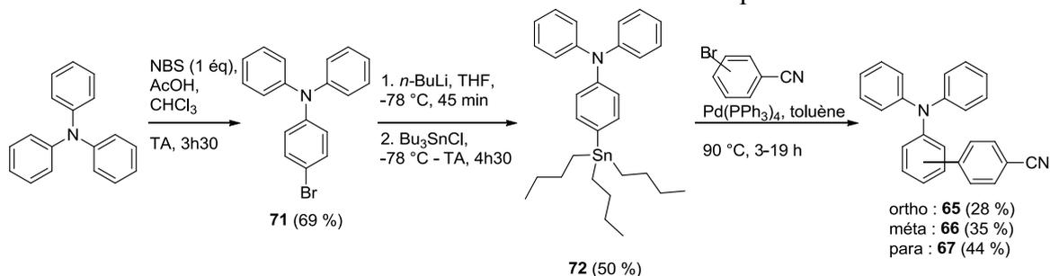
Figure 154. Synthèse des triphénylaminophénylnitriles **65**, **66** et **67**
