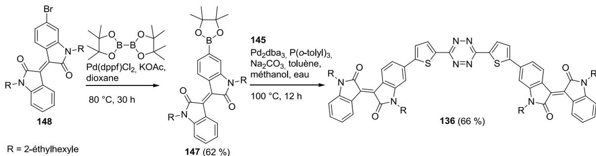
Figure 206. Synthèse du composé **136** par couplage de Suzuki-Miyaura
