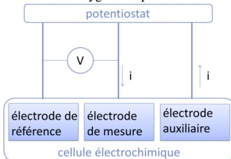
Figure 230. Schéma du montage à trois électrodes
