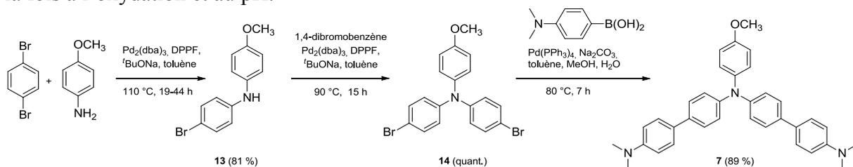
Figure 79. Synthèse de **7** par couplages de Hartwig-Buchwald suivis d'un couplage de Suzuki-Miyaura
