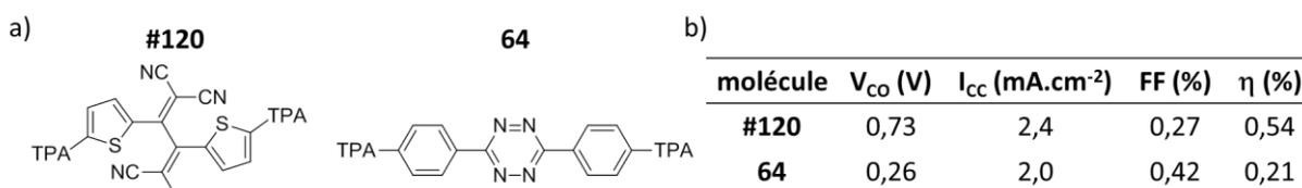
Figure 196. Comparaison de **#120** et **64** a) structure, b) caractéristiques photovoltaïques
