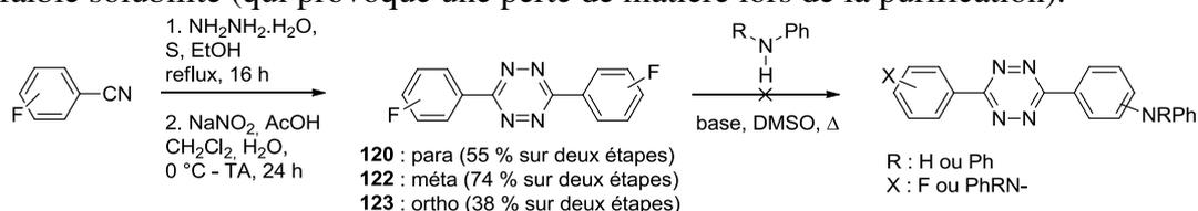
Figure 177. Synthèse des di(fluorophényl)-s-tétrazines et substitution nucléophile aromatique par une amine
