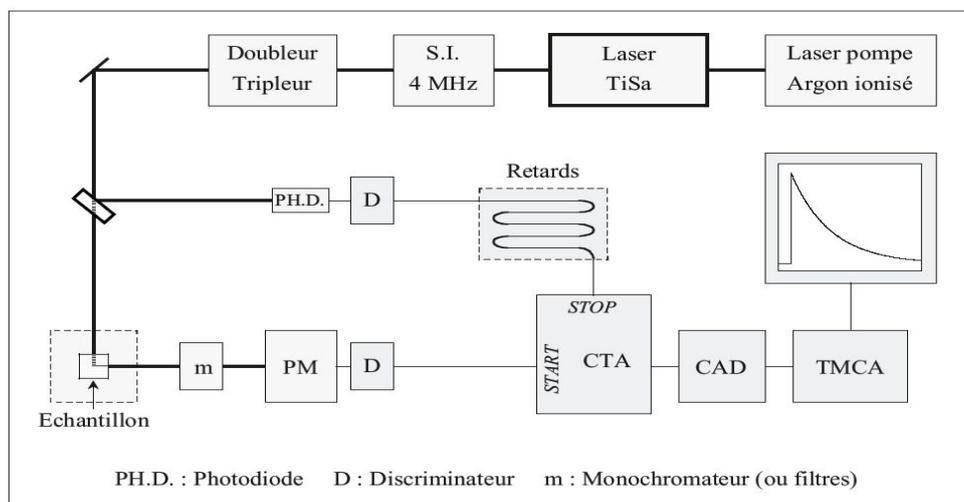
**Figure 232. Montage expérimental pour l'acquisition des déclin de fluorescence. S.I. : sélecteur d'impulsion ; PH.D. : Photodiode ; D : Discriminateur ; m : monochromateur (ou filtres) ; PM : photomultiplicateur ; CTA : Convertisseur Temps-Amplitude ; CAD : Convertisseur Analogique-Digital ; TMCA : carte d'acquisition**
