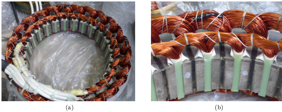
FIGURE 2.25: Prototypé de la structure hybride 24 aimants stator - 20 dents rotoriques : (a) Stator et (b) zoom sur une cellule de commutation
