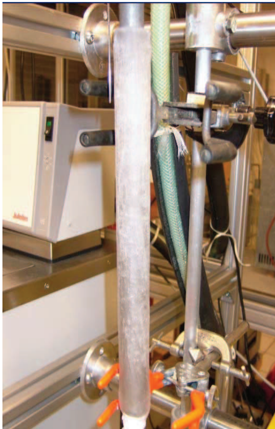
Figure C-6a. Image de la glace de salinité 6,82 g/kg récupérée dans le 1 ier cycle de dessalement de l'eau de mer
