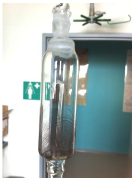
Figure I-4 : Photographies (après utilisation) du montage en silice utilisé pour purifier le soufre
