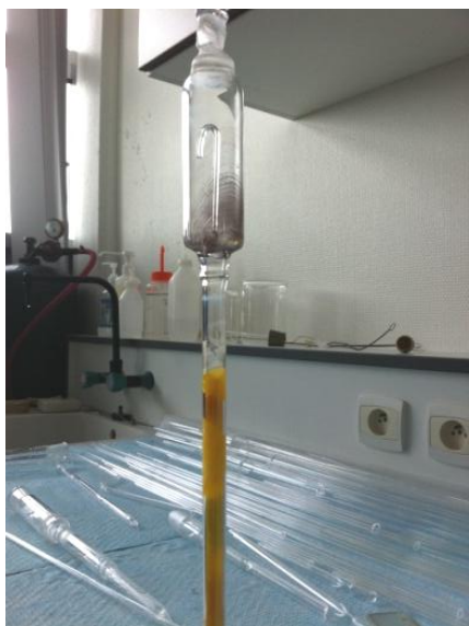
Figure I-4 : Photographies (après utilisation) du montage en silice utilisé pour purifier le soufre
