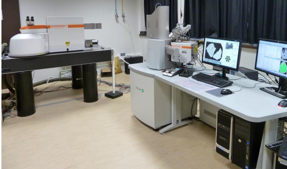
Figure IV.23 : Microscope Electronique à Balayage couplé à un spectromètre Raman utilisé pour ces analyses (BRGM – Orléans)
