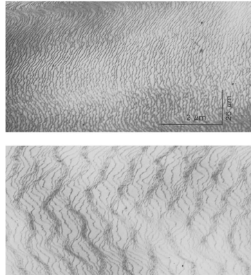
Figure II.2 – Images par Reflexion Electron Microscopy du changement de morphologie d’une surface vicinale de Si(111) induite par le passage d’un courant continu (extraite de la référence [35]).
