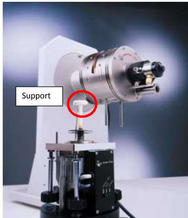
Figure II.4: Support et four pour la DRX en température [Bruker].
