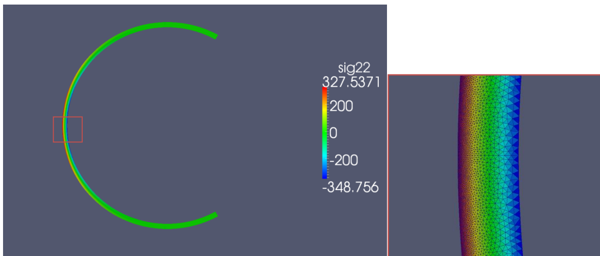
II-F. 28 : Champ de contrainte \sigma_y pour un déplacement imposé de 0,2 mm
