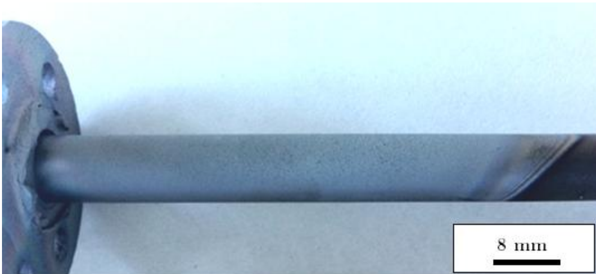
II-F. 9 : Inhomogénéité radiale du dépôt de SiC sur barreau de graphite
