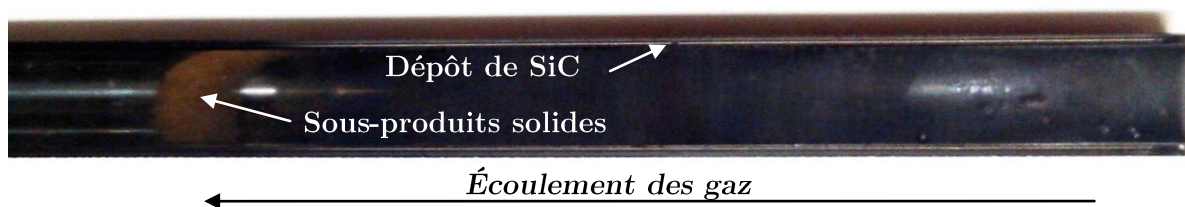
IV-F. 14 : Découpe longitudinale d'un tube élaboré en configuration statique
