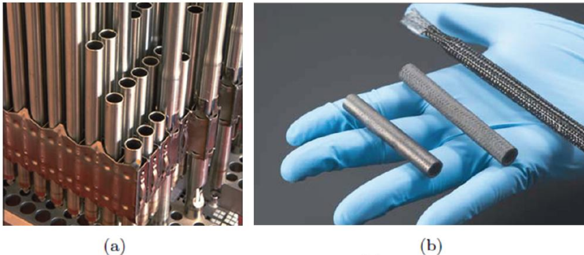
I-F. 4 : Crayons (Zircaloy) de combustible en fuseaux (a)- préforme et tubes composites SiC/SiC (b)
