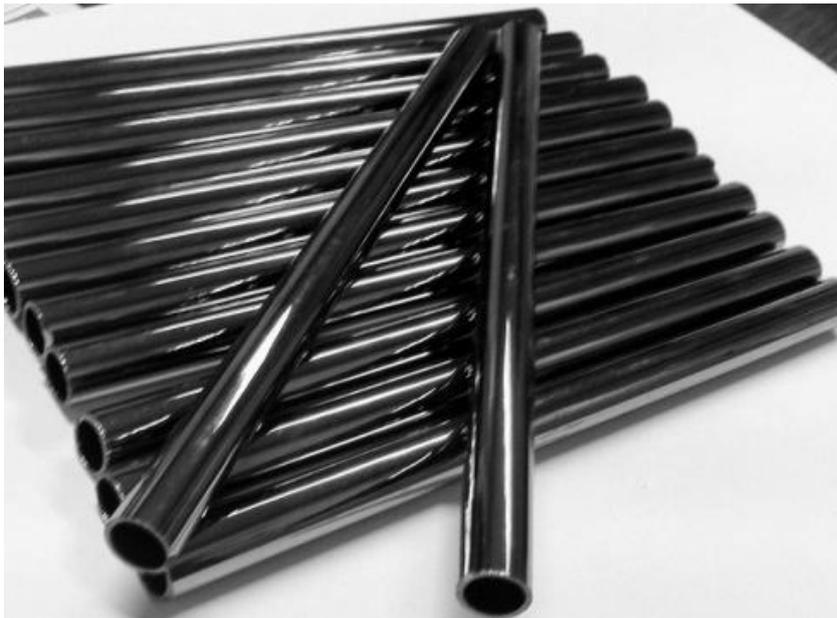
**II-F. 11 : Tubes de SiO<sub>2</sub> recouverts de PyC par LPCVD**
