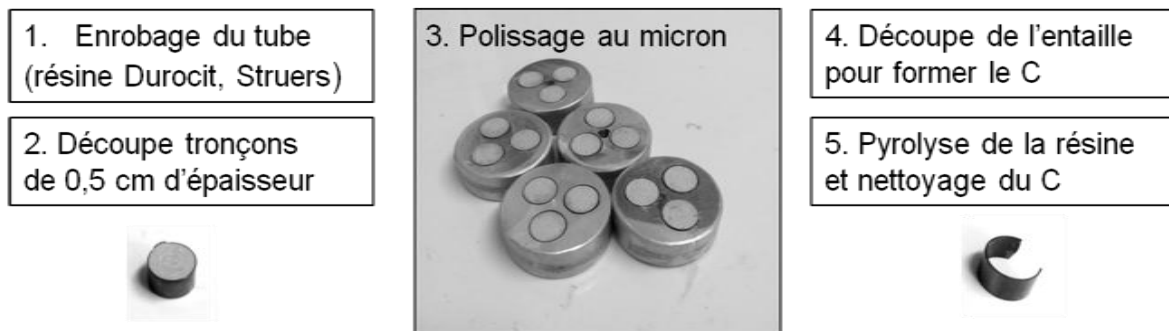
II-F. 24 : Schéma bilan de la préparation d'éprouvettes en C
