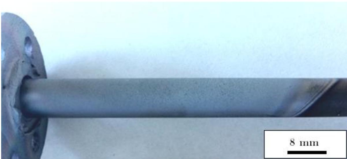
II-F. 9 : Inhomogénéité radiale du dépôt de SiC sur barreau de graphite
