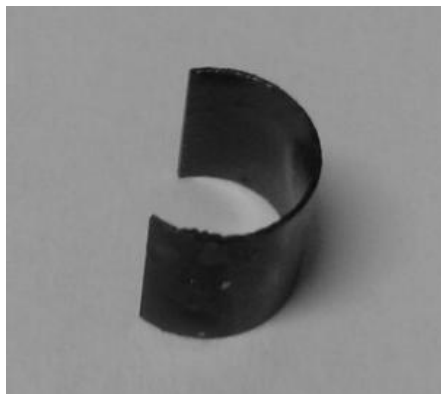
II-F. 22 : éprouvette SiC ( \alpha = 2 , T = 1100 °C, Q_{\text{tot}} = 500 sccm, V_0 = 0 ) en forme de C
