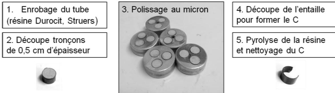
II-F. 24 : Schéma bilan de la préparation d'éprouvettes en C
