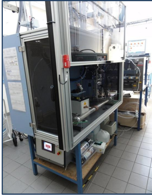
II-F. 5 : Réacteur CVD à pression atmosphérique installé au LCTS
