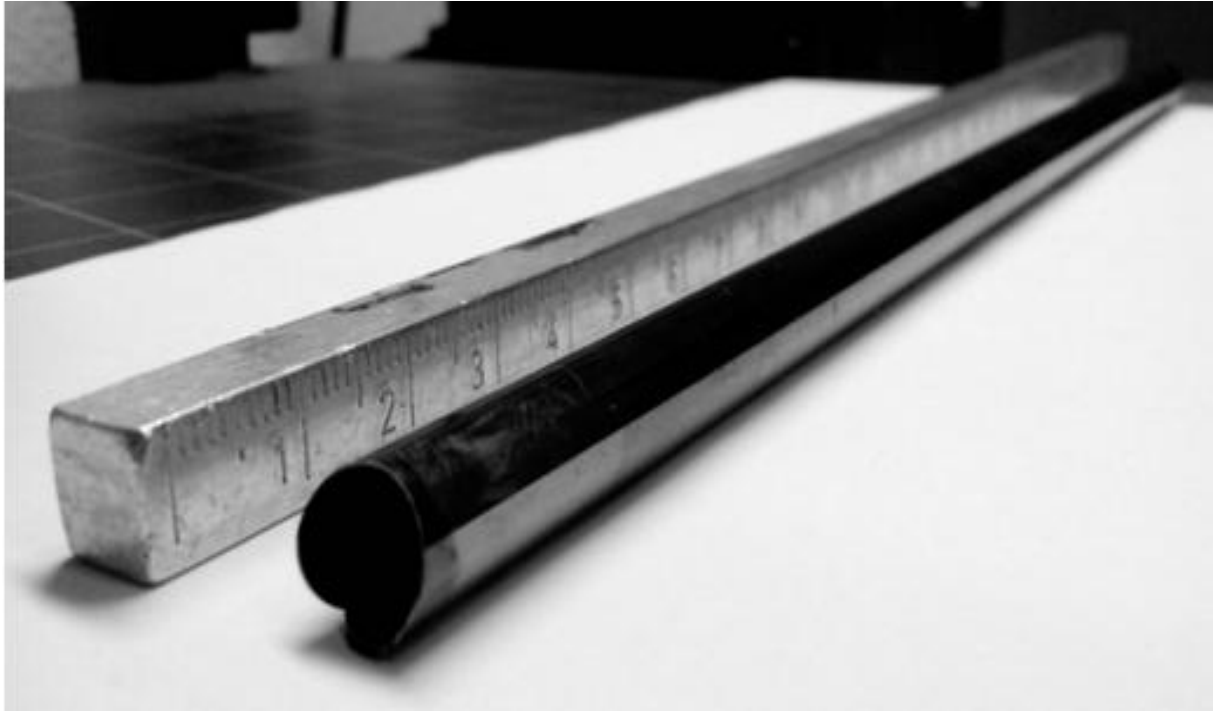
V-F. 6 : Tube de SiC réalisé selon les paramètres de référence ( \alpha = 3 , T = 1200 °C, Q_{\text{tot}} = 500 sccm, V_0 = 0,25 cm/min)
