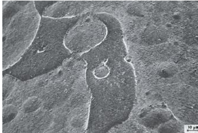
I-F. 20 : Intermédiaire réactionnel observé au cours de dépôt de SiC CNTD [BHA 2005]
