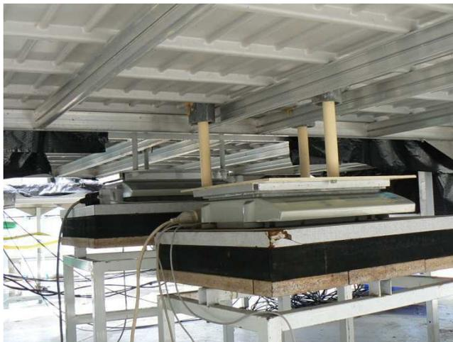
**Figure 21 : Balances constituant le système de mesure de la transpiration des plantes.**
