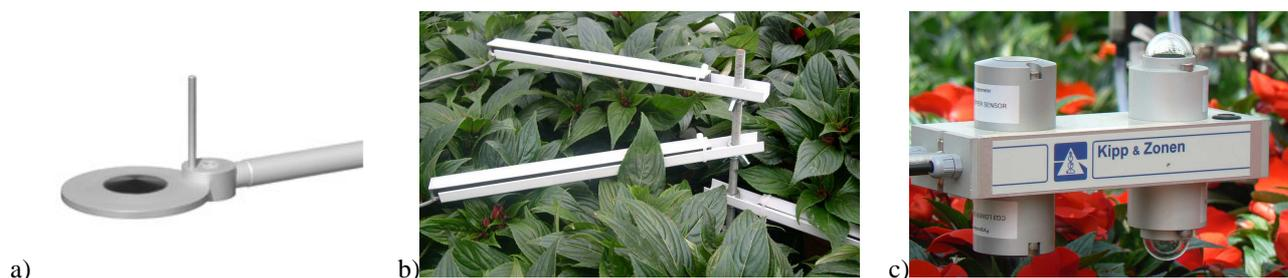
**Figure 20 : Capteur de rayonnement global (a), photosynthétiquement actif (b) et de courte et grande longueur d'onde (c).**
