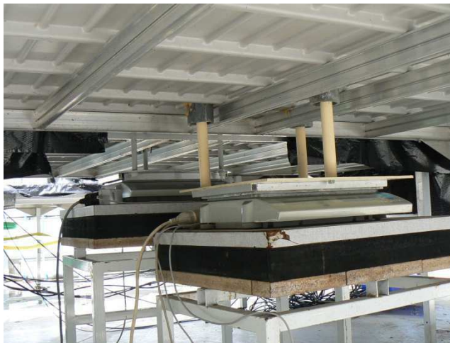
Figure 21 : Balances constituant le système de mesure de la transpiration des plantes.
