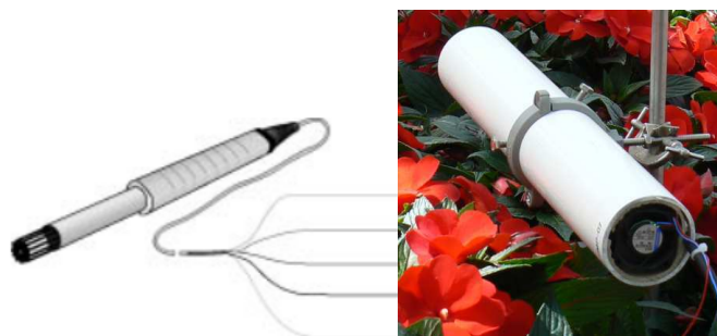
Figure 19 : Illustration d'une sonde de température et d'humidité et son abri ventilé.
