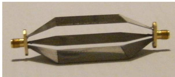
FIGURE 5.25 – Photographie de la cellule TEM réalisée.
