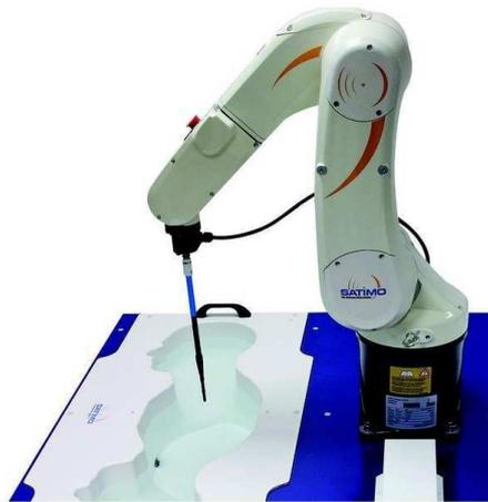
FIGURE 1.5 – Mesure du champ électrique sur un fantôme (photographie issue d'un document technique de la société Satimo).
