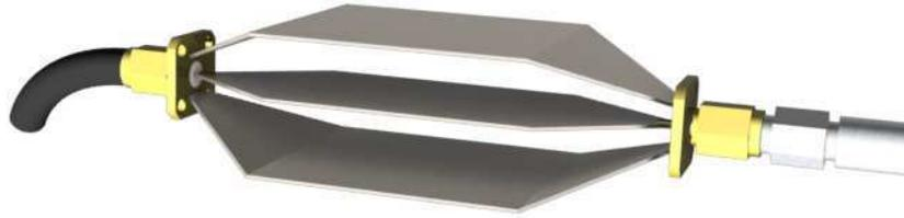
FIGURE 1.2 – Représentation tridimensionnelle d'une cellule TEM ouverte.
