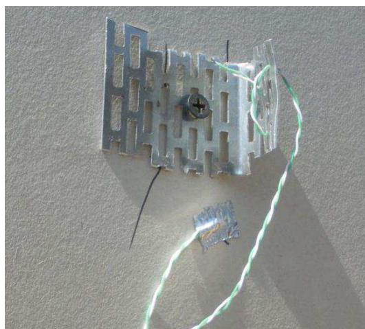
Figure 2.16 : Deux thermocouples placés. Un sur la plaque de BA13 et l'autre dans la lame d'air
