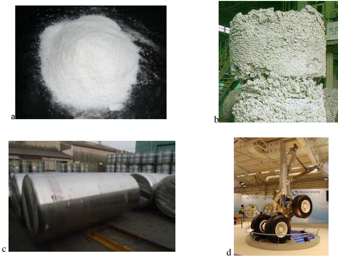
Figure 2 : Titane : de l'oxyde au produit fini (oxyde de titane(a), cake (b), lingot (c) et train d'atterrissage (d)) [6].
