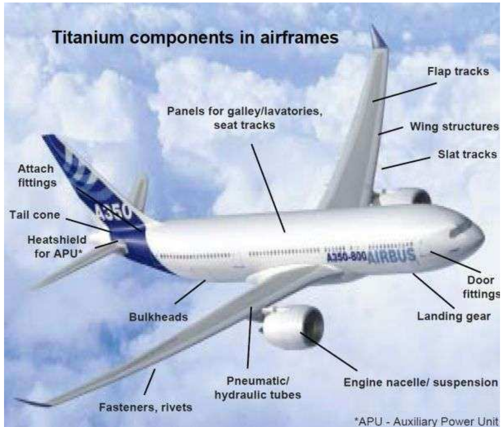
Figure 3 : Composants aéronautiques en alliages de titane [7].
