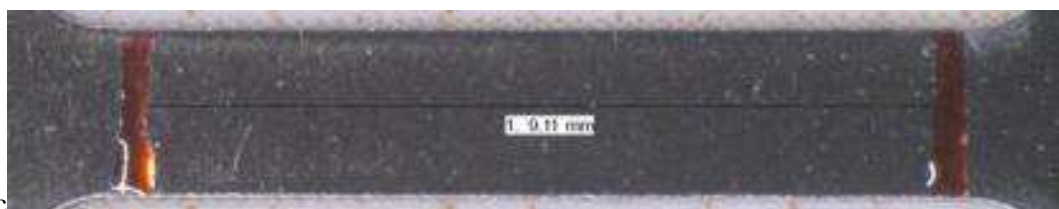
Figure 69 : (a) Courbes d'un essai ex situ sur Ti-5553 : arrêt de l'essai à un niveau de déformation plastique résiduel de 0,2% selon la méthode présentée au paragraphe précédent. Vérification après essai par mesure sous loupe binoculaire grâce à l'utilisation de marqueurs physiques avant (b) et après essai (c) : (L-L_0)/L_0 = (9,11-9,09)/9,11 = 0,22\% .
