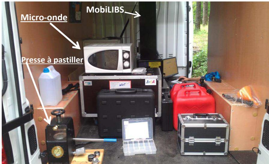
**Figure 2-5** Appareillages de préparation des échantillons utilisés lors des campagnes de mesures LIBS sur site
