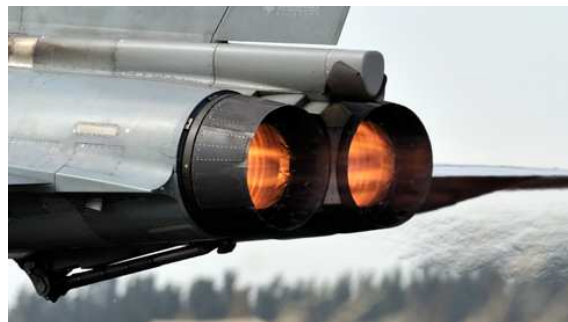
FIGURE 2 – Avion de combat Rafale équipé de ses volets en composite à matrice céramique.
