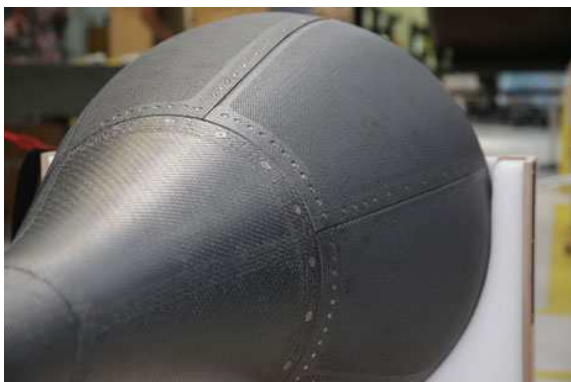
FIGURE 1 – Cône central d'éjection en CMC testé en 2012 sur CFM56 en vol sur avion Airbus © Anne Jolivet / Equivox / Safran.
