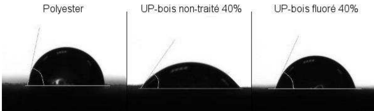
Figure IV-21 – Images d'angles de contact obtenus pour le polyester, le composite avec 40% de farine de bois non-traitée et le composite avec la farine fluorée
