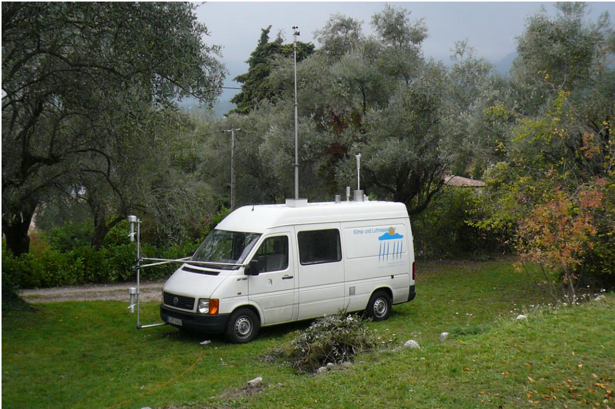
Figure 174. Le camion laboratoire : à l'arrière du camion, la tête de prélèvement des PM_{10} ; au centre, le mas télescopique pour la mesure de la force et de la direction du vent ; et à l'avant, les appareils pour la mesure des différentes températures. Vue vers le nord-ouest. (© Michelot).
