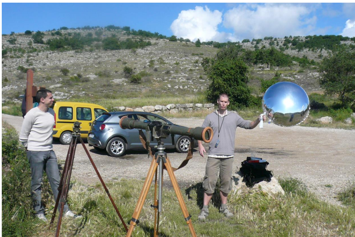
Figure 101. CLB prêt à être lâché le 06/06/2011 vers 10h30 près du col de Vence. Au 1 er plan : à gauche, le théodolite, à droite, le télémètre. Vue vers le nord-ouest. (© Michelot).
