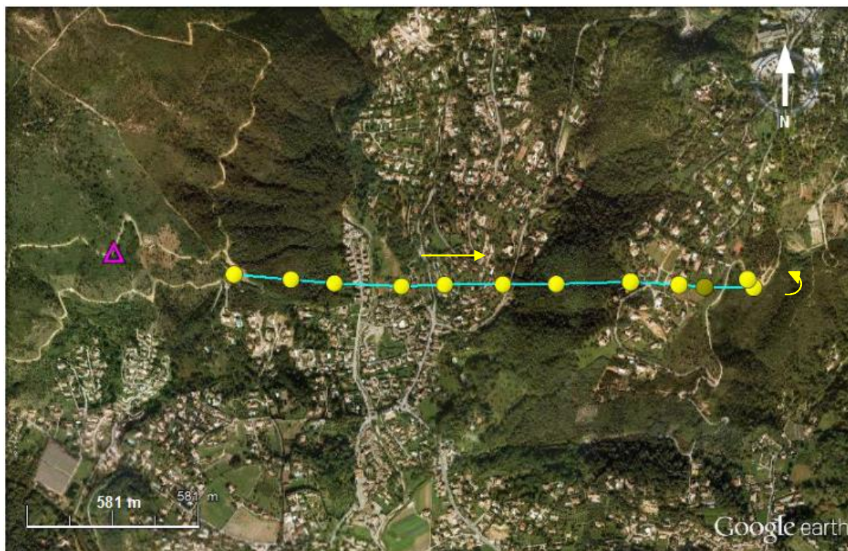
Figure 141. Parcours du CLB lâché depuis le DFCI du Peygros au-dessus d'Auribeau-sur-Siagne (triangle rose). Le 28/02/2012 à 07h58. Les flèches jaunes indiquent le sens du mouvement du CLB. Notez le retour du CLB sous l'effet du flux synoptique d'est.
