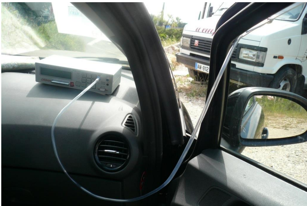
Figure 93. Analyseur de particules Grimm 1.108, embarqué dans un véhicule lors des mesures itinérantes. (© Michelot).
