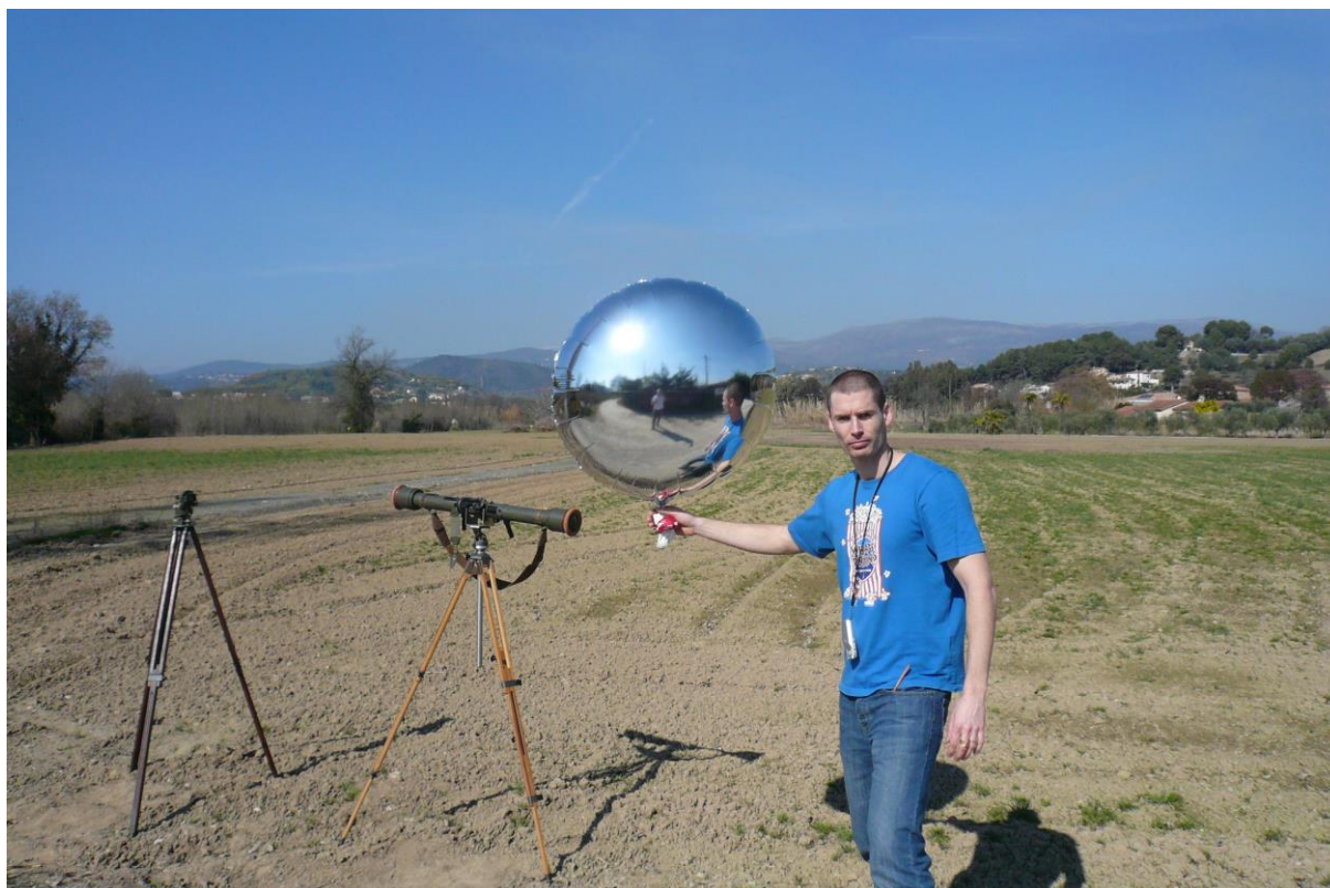
Figure 13. CLB prêt à être lâché le 28/02/2012 vers 12h, à la Roquette-sur-Siagne, au lieu-dit des Prés Neufs, vue vers le nord-est. Au 1 er plan : à gauche, le théodolite, à droite, le télémètre. (© Michelot).
