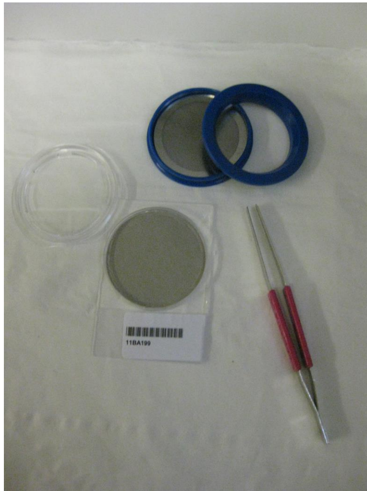
Figure 229. Filtres quartz prêts à être analysés. (© Favez).
