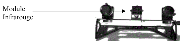
Fig. 3.13. Présentation du hardware faceLAB pour l'enregistrement de mesures oculaires.
