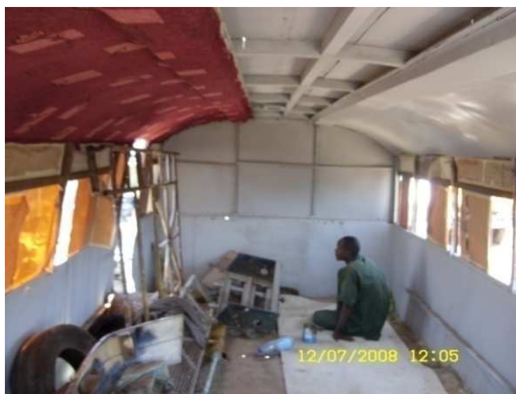
Photo 13: Intérieur d'un autocar pendant la phase de tapisserie, La structure métallique est cachée à l'aide des moquettes et de la colle achetées sur le marché de N'Djaména. Ngar-odjilo M., 2008
