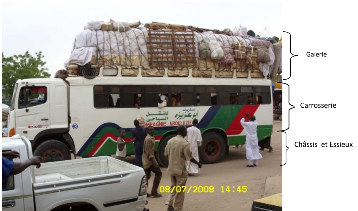
Photo 14 : Un autocar "fabriqué" au Tchad et prêt au voyage. Le chargement au dessus du véhicule dépasse les 1,50 m. ce qui réduit grandement l'équilibre du véhicule pendant le voyage. Ajoutée à la vitesse, ce chargement provoque très souvent d'accidents. Ngar-odjilo M., 2008
