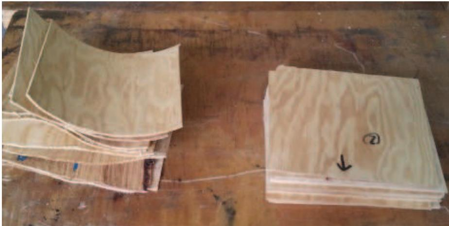
FIGURE 2.16 – Déformation des plis suite au séchage à l'air libre (à gauche) sous vide avec cycles (à droite)
