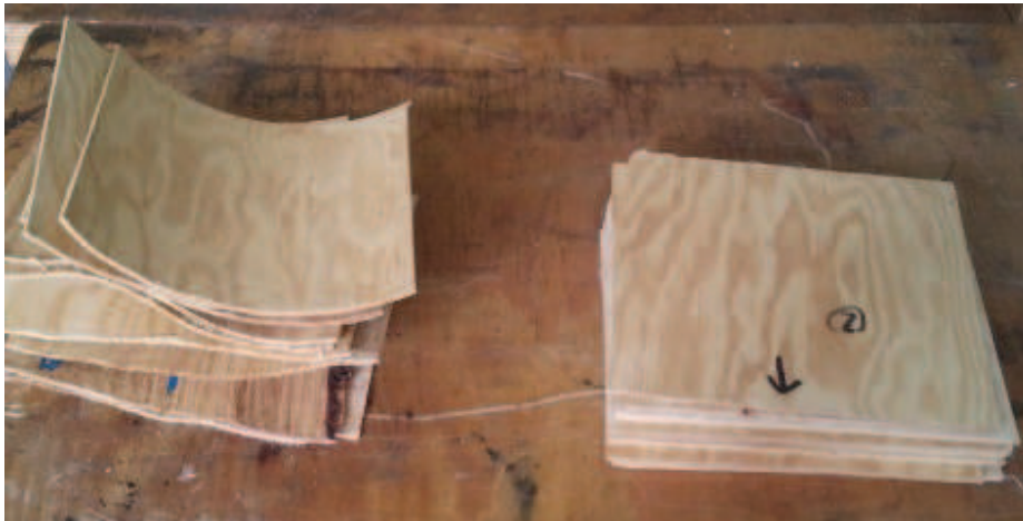
FIGURE 2.16 – Déformation des plis suite au séchage à l'air libre (à gauche) sous vide avec cycles (à droite)
