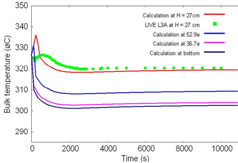
Figure 11. Evolution de la température du bain à différents niveaux.
