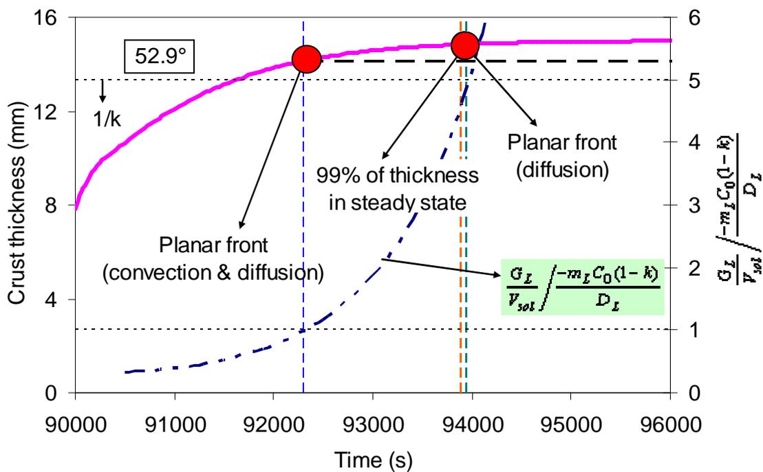
Figure 8. Temps caractéristique pour l'obtention l'un front plan à 52.9° dans la phase 7 kW.
