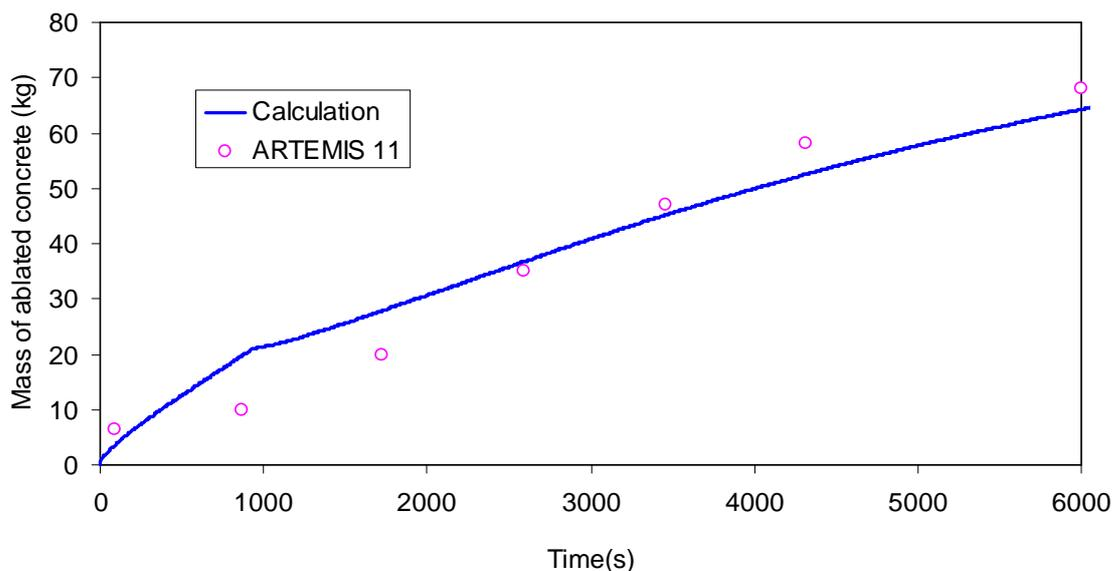
Figure 18. Evolution de la masse ablatée du béton dans ARTEMIS 11.
