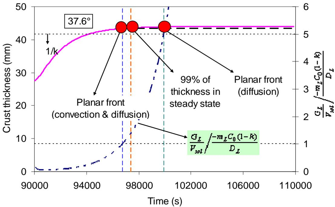
Figure 6. Temps caractéristique pour l'obtention l'un front plan à 37.6° dans la phase 7 kW.
