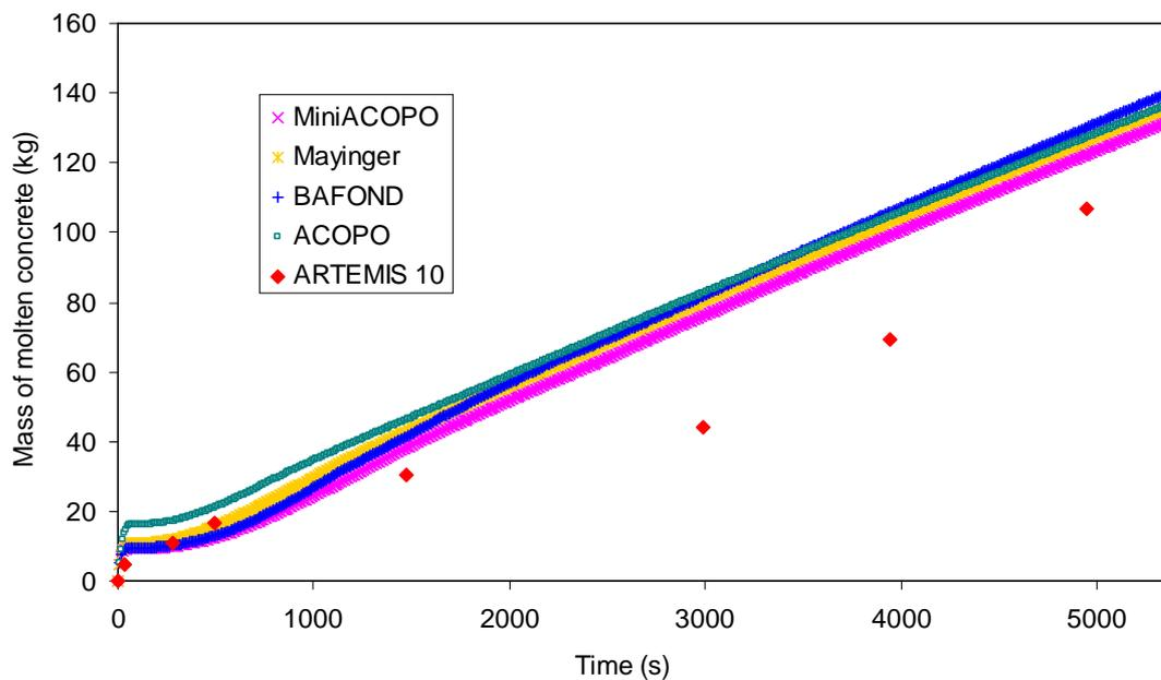
Figure 27. Evolution de la masse ablatée du béton calculée avec des différentes corrélations de Nusselt.
