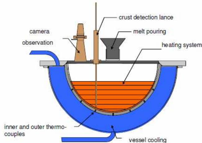
*Figure 2-3. LIVE test vessel [Kretzschmar et Fluhrer, 2008].*
