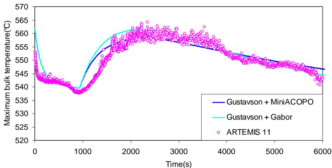
Figure 17. Evolution de la température maximale du corium dans ARTEMIS 11.
