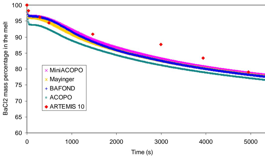
Figure 28. Evolution du pourcentage massique de  $BaCl_2$  dans la cavité du corium.
