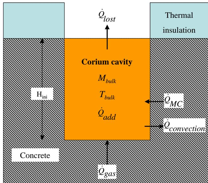
Figure 16. Configuration pour le modèle 0D d'ARTEMIS 11.
