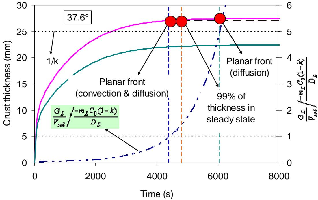
Figure 5. Temps caractéristique pour l'obtention d'un front plan à 37.6° dans la phase 10 kW.
