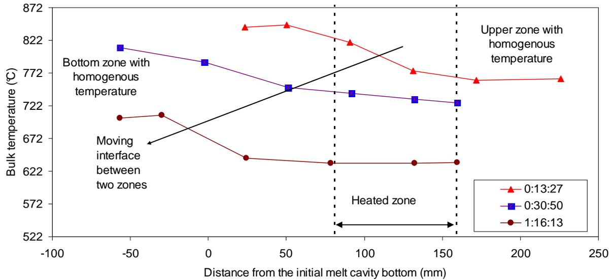
Figure 22. Deux zones avec des températures quasi-uniformes dans la cavité de corium.
