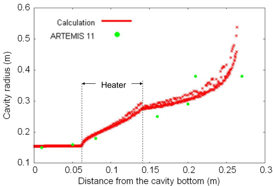
Figure 20. Evolution de la forme de la cavité à la fin d'ARTEMIS 11.
