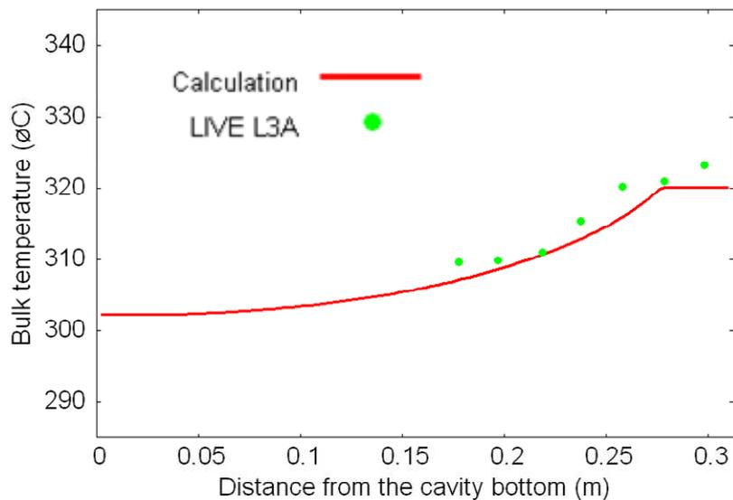
Figure 12. Profil vertical de la température du bain en régime permanent.
