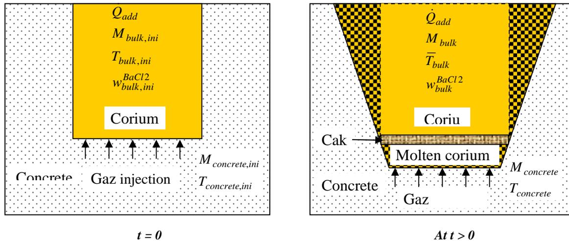
Figure 25. Configuration du modèle 0D d'ARTEMIS 10.
