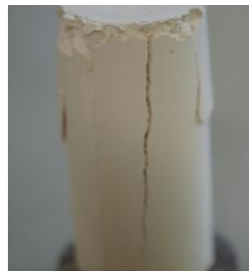
Figure 3.23 : Eprouvette d'échantillon de plâtre A après un essai de compression. Visualisation de la propagation des fissures parallèles à la direction du chargement (rupture fragile).
