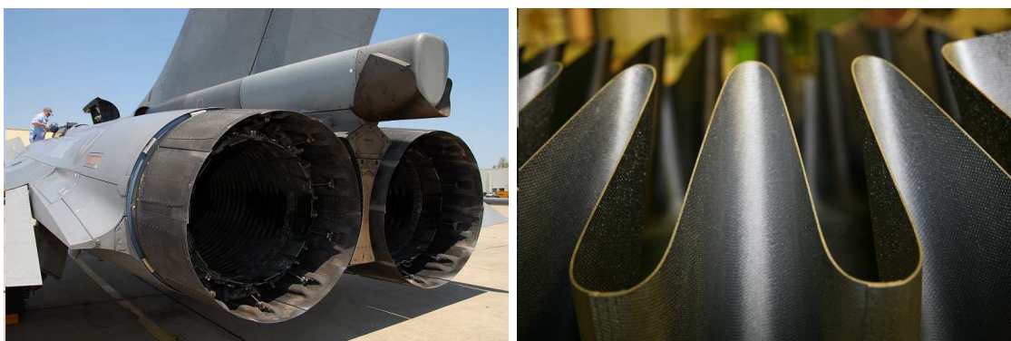
(a) Volets froids en composites thermostructuraux C/SiC (Avion de combat Rafale). (b) Prototype de mélangeur en CMC sur moteur CFM56-5C.
