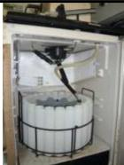
Polyéthylène<br>24 x 0.9 L | Polyéthylène       | Péristaltique | MES/MVS/DCO<br>Vitesse de chute<br>Analyse métaux,<br>Analyse glyphosate,<br>glyphosate ammonium, AMPA |
