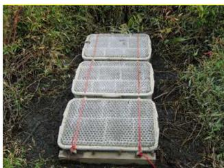
Figure 6-5. Piège à sédiments
