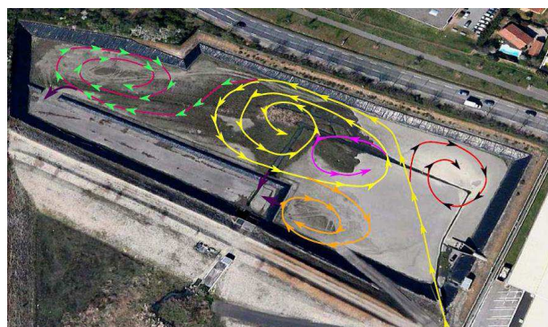
Figure 6-3. Zones de recirculation simulées (Yan 2013)
