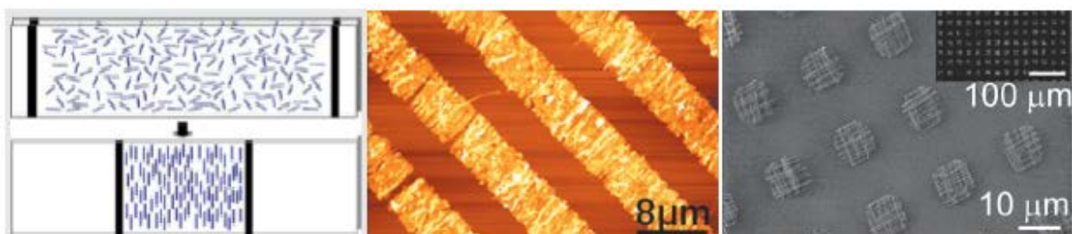
Figure 2.4: Assemblage de nanofils par Langmuir-Blodgett [17], [6].
