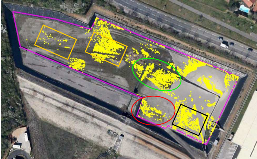
Figure 2 Zones de dépôt simulées à l'aide la condition limite BTKE en fonction des vitesses de chute des particules (nouvelle condition limite proposée) – une distribution non uniforme des vitesses de chute des particules a été considérée à l'entrée du BDR
